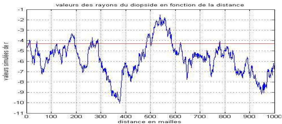
Figure 18 : Valeurs simulées du rayon des grains (en échelle logarithmique) en fonction de la distance (mailles) avec une portée a=200m
