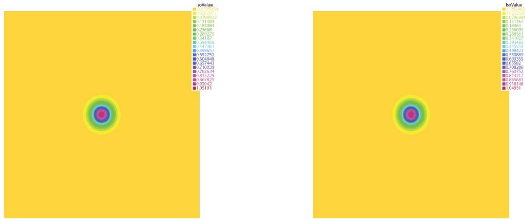
FIGURE 2.26 – Solution théorique (à gauche) et solution numérique (à droite) après adaptation du maillage.
