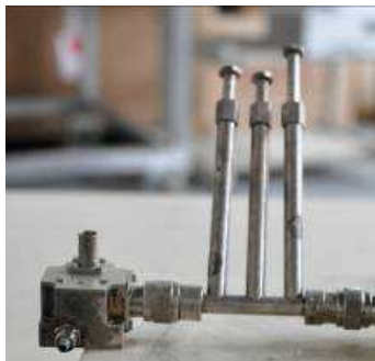
Figure 2.15 Charge de 50 \Omega et transformateur d'impédance à trois stubs.
