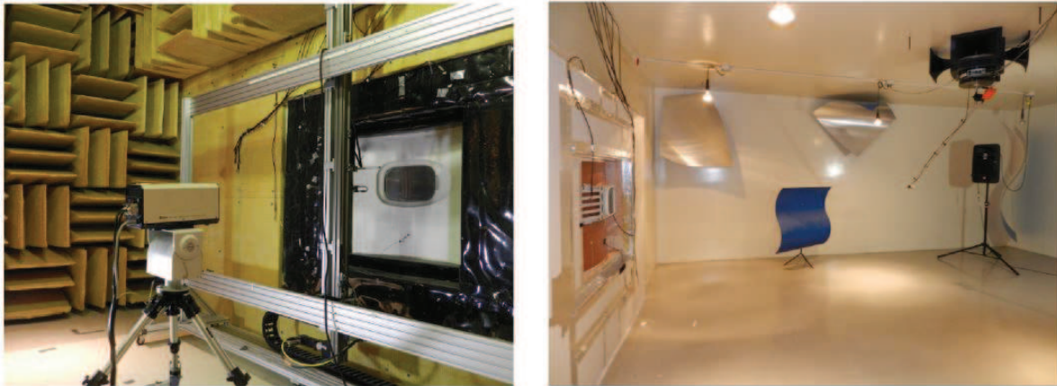
Figure 6.22 Dispositifs pour les mesures intensimétriques et vibratoires côté chambre anéchoïque (gauche) et source primaire côté chambre réverbérante (droite).
