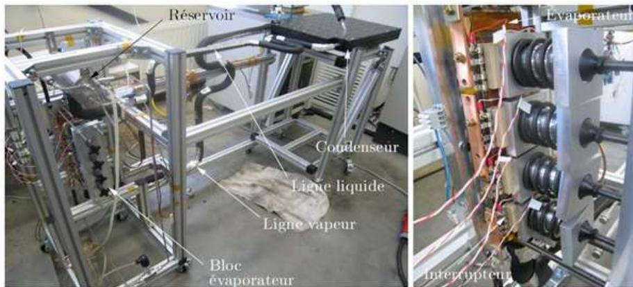
FIGURE 4.2: dispositif expérimental de la CPLIP testé en février 2006, Lossouarn [7]
