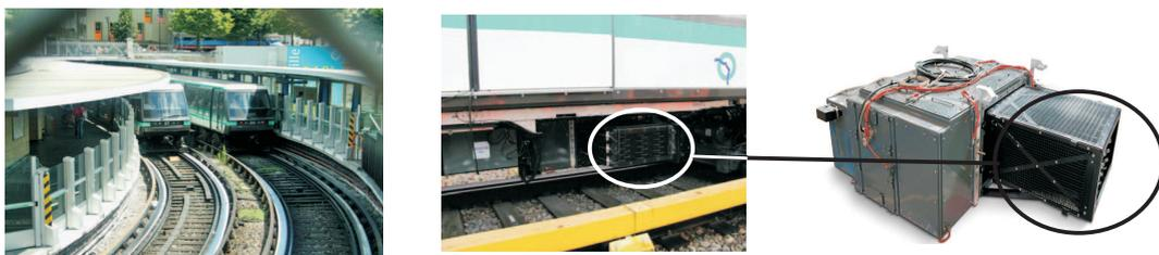
FIGURE 1.7: test d'une CPLIP sur une rame du métro parisien (RATP).
