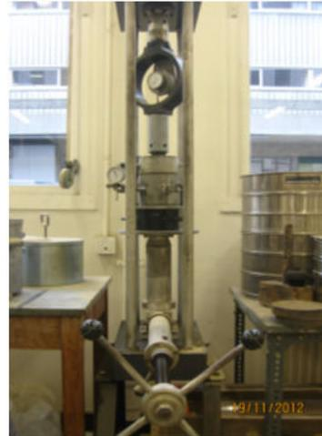
Figure 2.11: Compactage à la presse hydraulique
