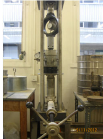
Figure 2.11: Compactage à la presse hydraulique
