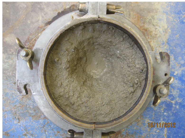
Figure 4.2a: Photo du cône d'érosion à la fin du jet
