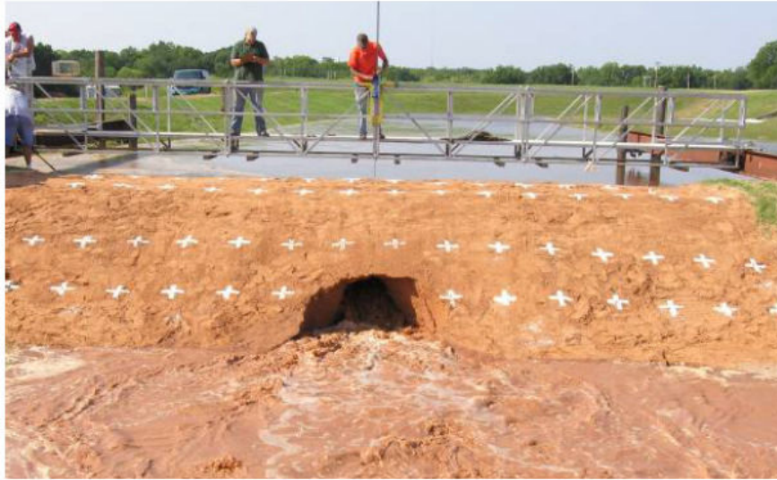
Figure 1.20: Essai d'érosion de conduit, 9 minutes après l'initiation de la rupture de conduit (Wahl et Ergodan, 2008)
