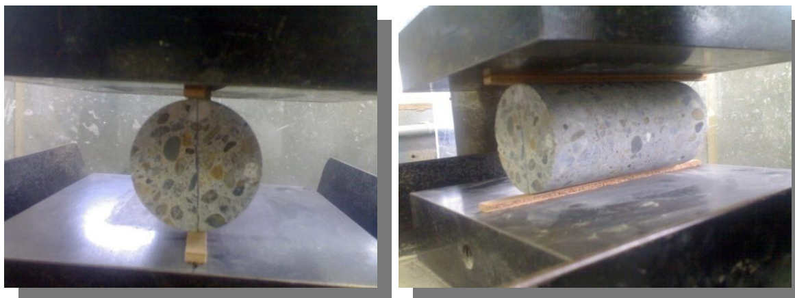
Figure II-4 : Dispositif d'essais de fendage sur des éprouvettes de la poutre témoin B2T.
