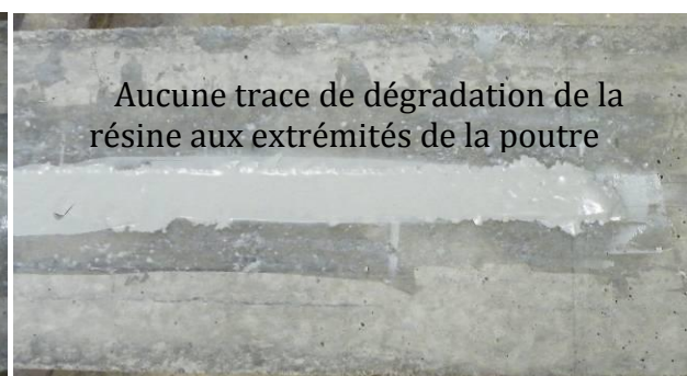
Figure III-20 : Mode de ruine de la Poutre B10-1PA (Pull-out du jonc de carbone avec écrasement du béton comprimé).
