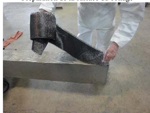
Mise en place manuellement le tissu composite
