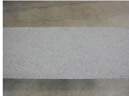
Préparation de la surface du collage
