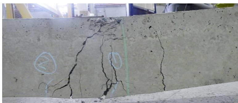
Figure III-17 : Mode de ruine de la poutre non-réparée B12-0.
