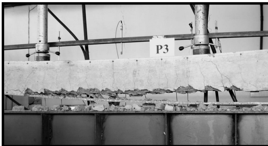
Figure I-18 : Modes de ruine précoce du renforcement (FRP) en flexion inséré par NSM.
