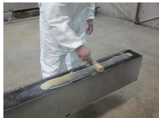
Deuxième couche de la résine sur le tissu composite (1 à 2 mm)
