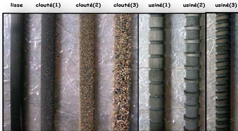
Figure I-12 : Configurations de surface (cloutage et usinage) développées au LMDC par (Al-Mahmoud et al. 2007).
