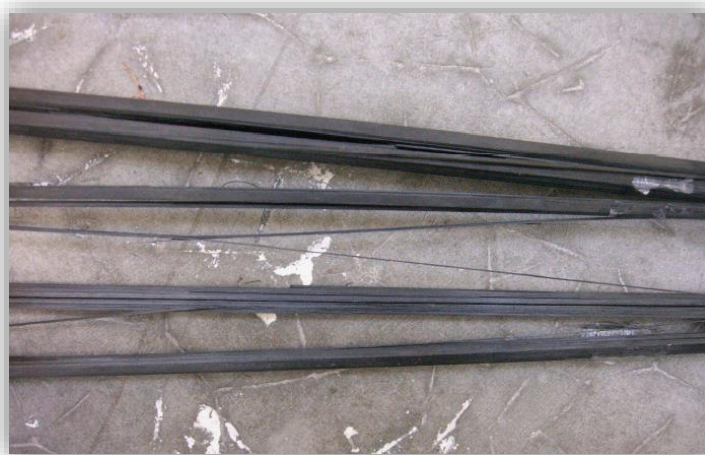
Figure II-5 : Mode de rupture à la traction des joncs de carbone par Al-Mahmoud et al. (2007).
