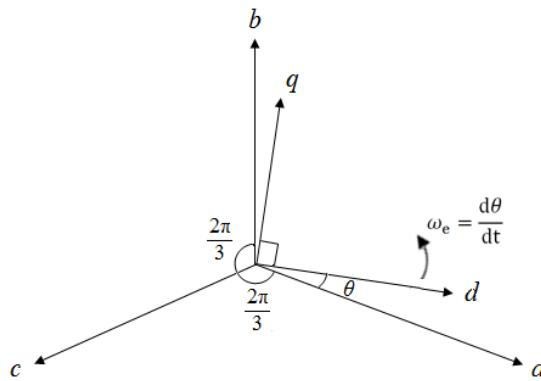
Fig. II.10. The generator-side synchronous rotation  $d$ - $q$  frame.
