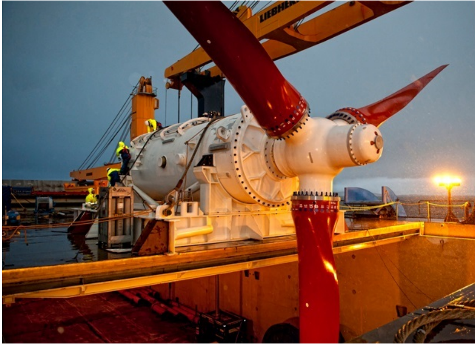
Fig. I.2. Andritz Hydro Hammerfest HS1000 turbine [13].
