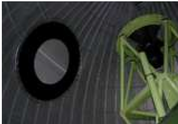
FIGURE 1.18 – Photo de l'écran installé au télescope McGraw-Hill 1.3m. L'écran est entouré d'un anneau sombre pour limiter la stray light
