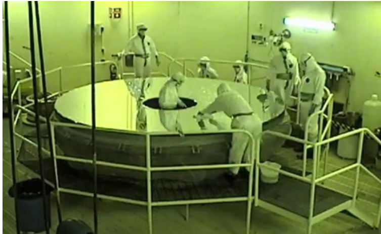
FIGURE 1.4 – Préparation à la ré-aluminisation du miroir primaire du CFHT en 2011. cfht.hawaii.edu
