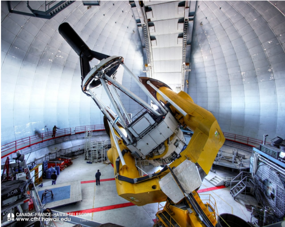
FIGURE 1.1 – Photo de l'intérieur du dôme au CFHT. MegaPrime est en haut à gauche (en noir), attaché à l'araignée. Le miroir primaire est au centre de l'image, en face de MegaCam.
