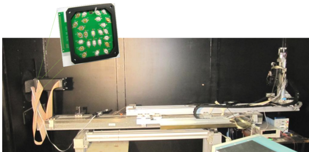
FIGURE 4.3 – Dispositif pour la cartographie spatiale des champs lumineux émis par les LEDs. Les LEDs sont à gauche et les photodiodes leur font face, à droite.
