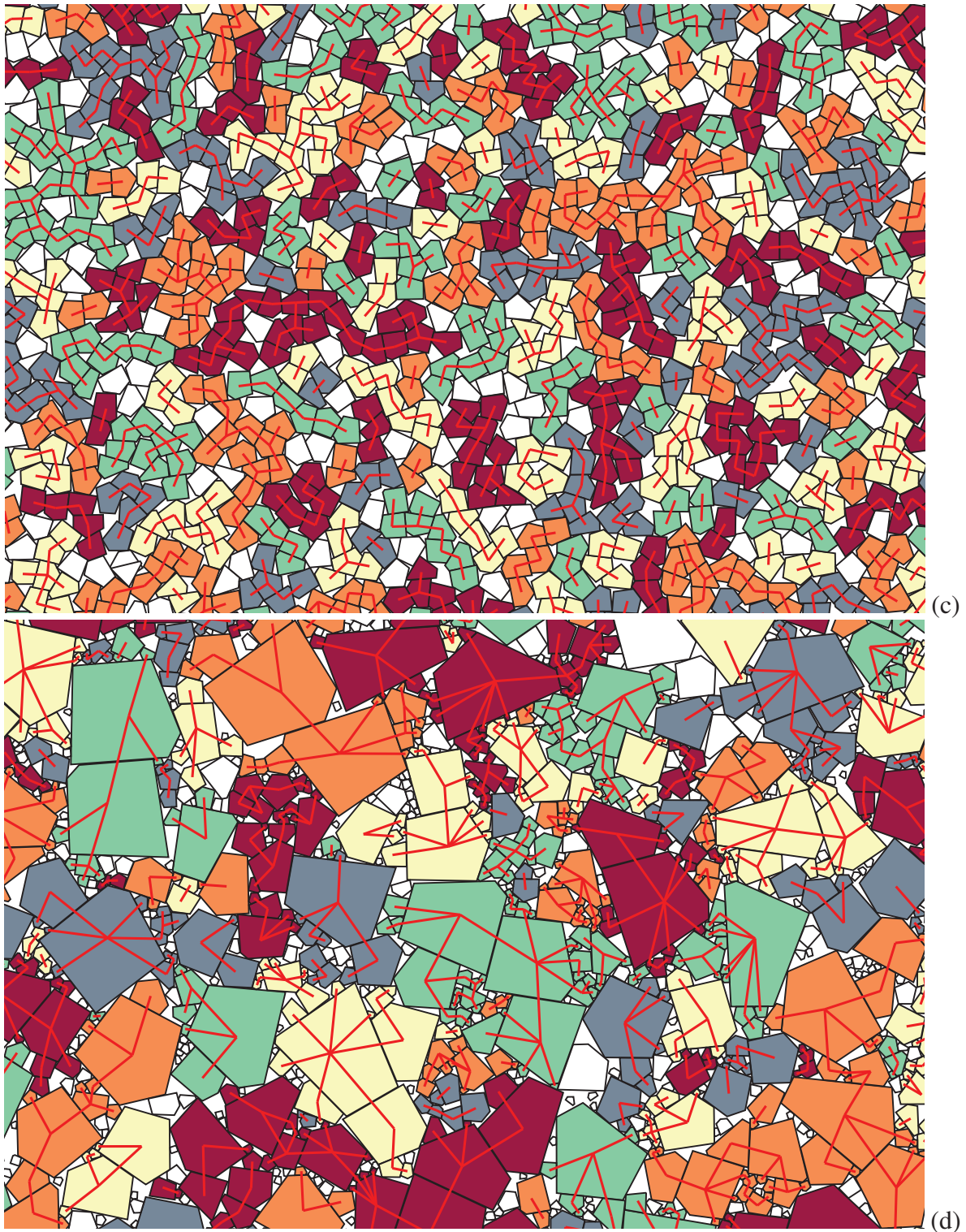
FIGURE 5.16. – Clusters des particules connectées par contacts côté-côté pour (s, \delta) = (0, 01, 0) (a), (s, \delta) = (0, 9, 0) (b), (s, \delta) = (0, 01, 1) (c) et (s, \delta) = (0, 9, 1) (d). Les clusters sont représentés par différentes couleurs (vert, orange, pourpre et rouge cardinal). Les contacts côté-côté sont aussi représentés par une ligne rouge reliant les centres des deux particules. Les particules flottantes sont en blanc.
