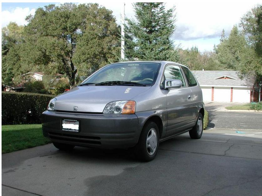
FIGURE 1.14 – Véhicule Honda EVplus avec une batterie NiMH.
