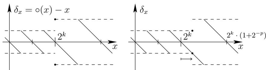
FIG. 4.1 – Bornes de l'erreur absolue aux alentours d'une puissance de deux
