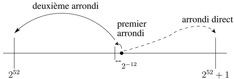
FIG. 8.2 – Franchissement des bornes d’erreur par double arrondi
