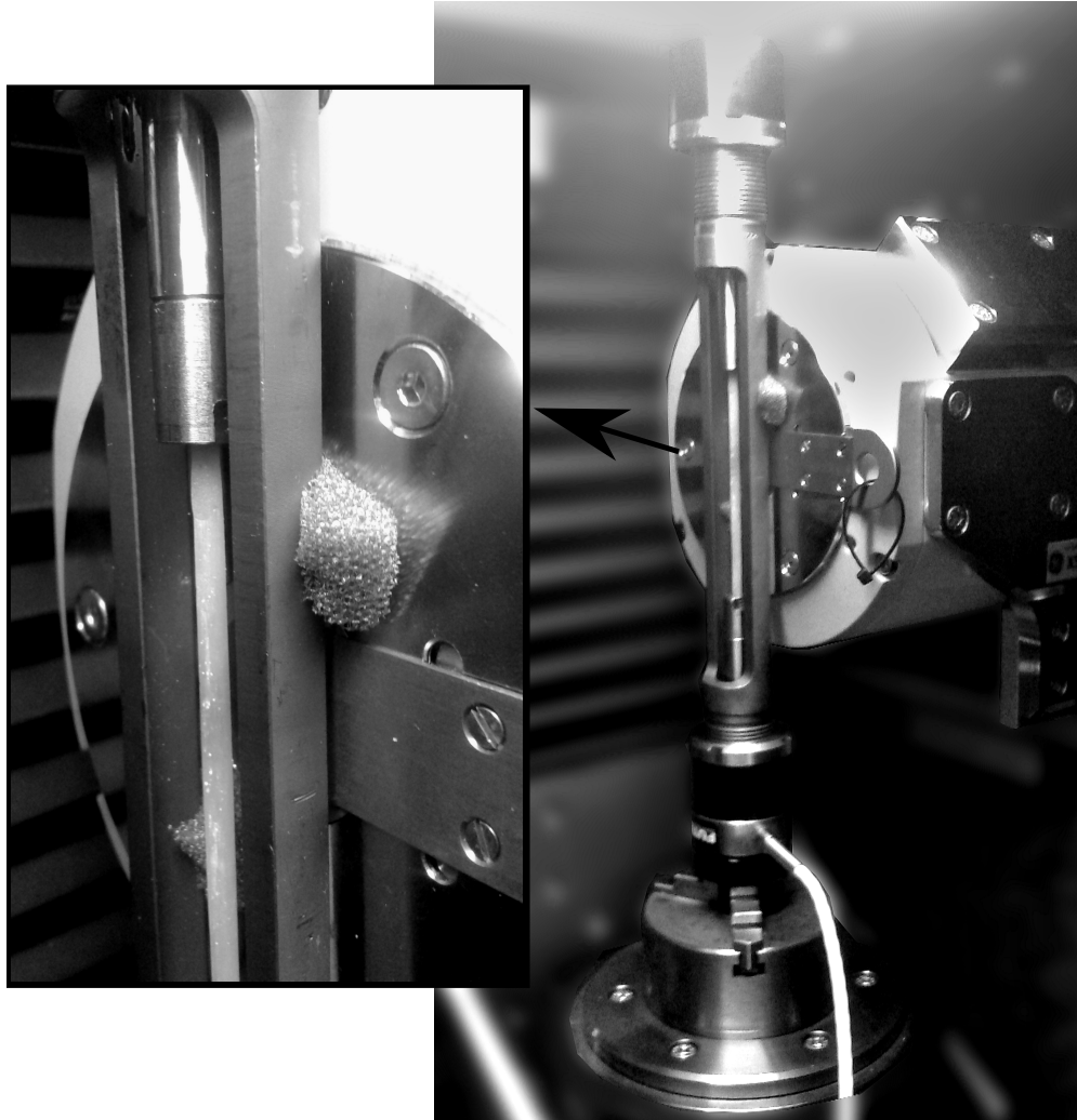
FIGURE 10.3 – Le dispositif expérimental installé à l'intérieur du tomographe. Des mousses sont placées entre le tube et la chambre de la source, afin d'éviter les impacts du tube lors de la rotation de la table.
