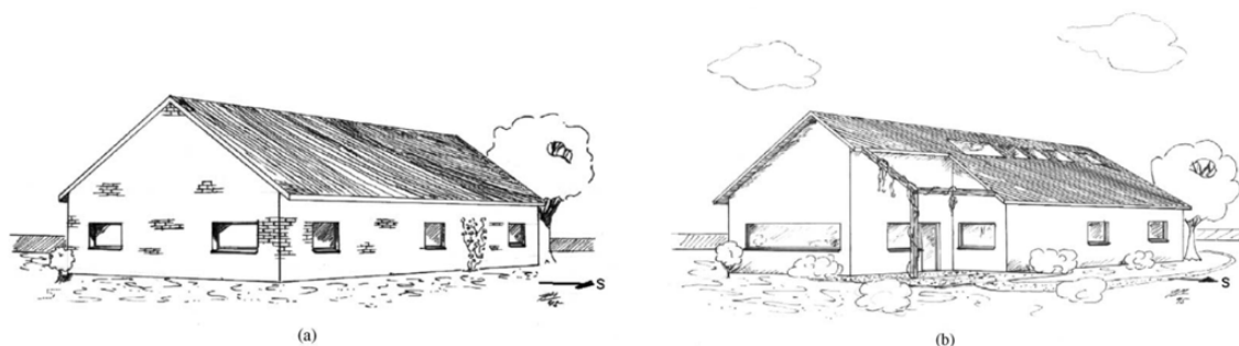
FIGURE 1.21: Solutions architecturales équivalentes du point de vue du besoin de chauffage : a) privilégie l'isolation, et b) privilégie les apports solaires ( Coley et Schukat, 2002 )
