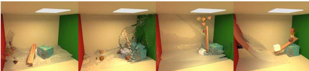
FIG. 3.4 – Interactions liquide-solide rigide par la méthode de domaine fictif, en présence de plusieurs solides et d'une surface libre. Images extraites de [CMT04].
