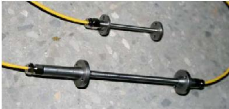
Figure 7 : Capteurs à réseaux de Bragg adaptés à la surveillance de structures en génie civil noyés dans le béton (photo CEMENTYS).
