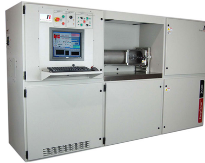
FIGURE 2.1 – Photographie d'un bâti de croissance, modèle EasyTube™ 3000, semblable à celui utilisé au LTM.
