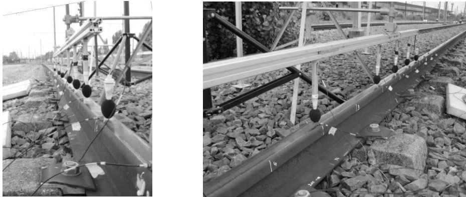
FIGURE 3.16 – Dispositif expérimental mis en oeuvre pour caractériser le comportement vibroacoustique d'un rail dans sa longueur.
