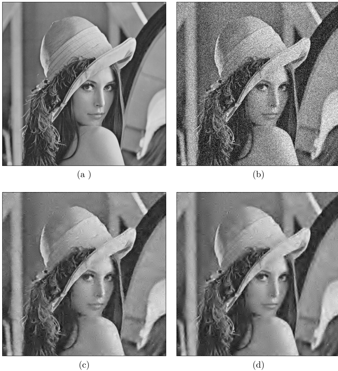
FIGURE 3.10 – Débruitage de Lenna avec \sigma = 40 : (a) image originale, (b) image bruitée ( PSNR = 16.1 db), (c) image débruitée avec les bandelettes ( PSNR = 27.0 db), (d) image débruitée avec les ondelettes ( PSNR = 26.2 db)
