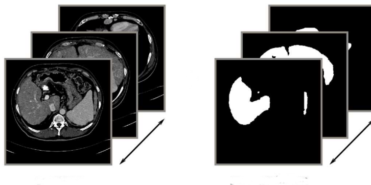
Figure 2.2 – Génération de maillages à partir d'images médicales. A gauche : Des coupes parallèles issues d'images scanner. A droite : La segmentation de ces images [Nes08] (Données issues de l'IRCAD).
