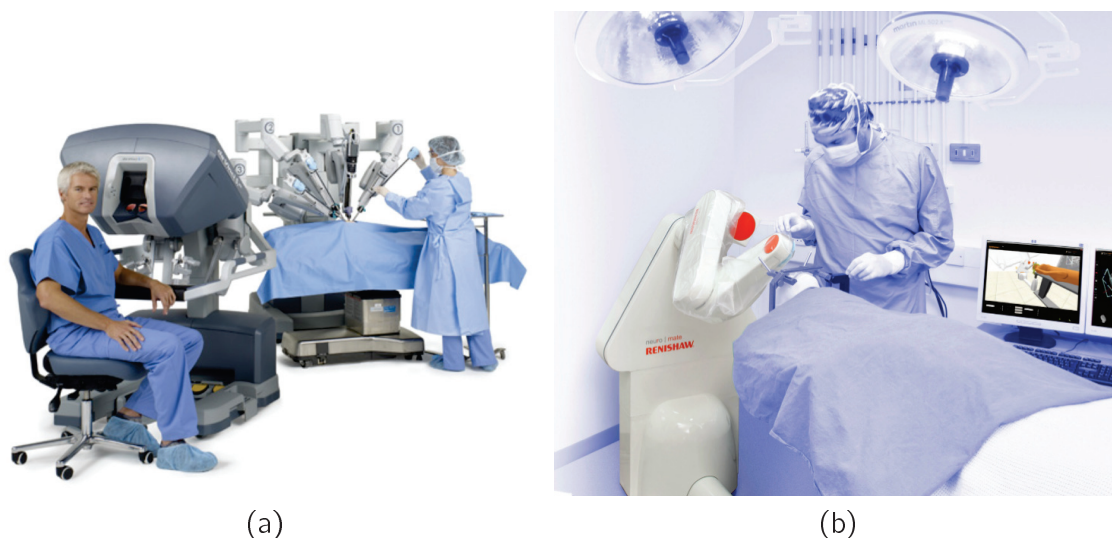
Figure 1.3 – Les robots chirurgicaux. (a) Le robot chirurgical Da Vinci pour la chirurgie mini-invasive ( www.davincisurgery.com ). (b) Le robot neuromate de Renishaw pour l'assistance à la neuro-chirurgie ( www.renishaw.com/en/10712.aspx )
