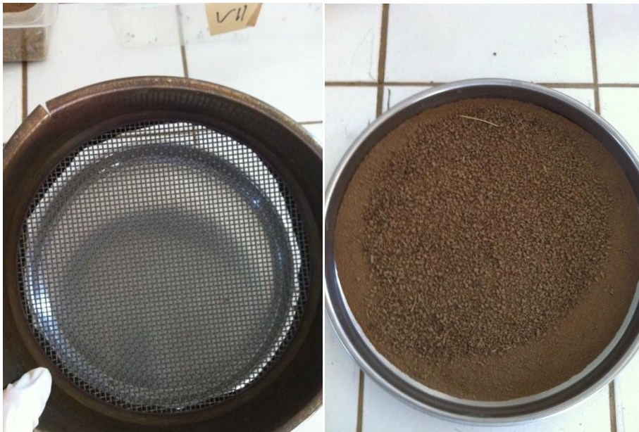
Figure B-5 : Phases de préparation des échantillons de sol avant leur analyse en laboratoire. Après avoir été séché, chaque échantillon est broyé à l'aide d'un pilon et d'un mortier (image du haut) puis sont tamisés à 2 mm (en bas à gauche) afin de récupérer la fraction fine (en bas à droite).
