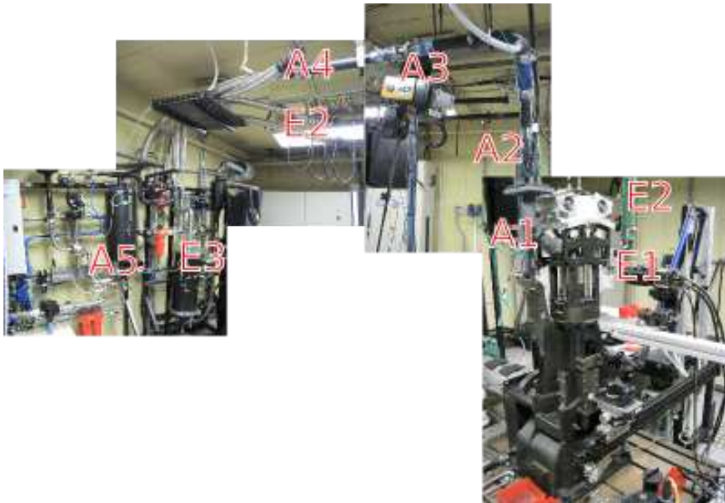
FIGURE 2.13 – Système d’admission et d’échappement Ligne d’Admission : A1 - Répartiteur d’admission. A2-Volume tampon 2. A3 - Débitmètre instationnaire. A4 - ligne tubulaire d’admission. A5 - Volume tampon d’admission. Ligne d’Échappement : E1 - Collecteur d’échappement. E2 - ligne tubulaire d’échappement. E3 - Volume de tampon de l’échappement.
