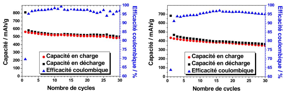
Figure 62 : Capacité spécifique en charge et en décharge et efficacité coulombique en fonction du nombre de cycle pour les cellules  $\text{Na}/\text{GeV}_4\text{S}_8$  (à gauche) et  $\text{Na}/\text{GaV}_4\text{S}_8$  (à droite). Les potentiels de coupure sont de 0,3 V en réduction et de 2,0 V en oxydation.
