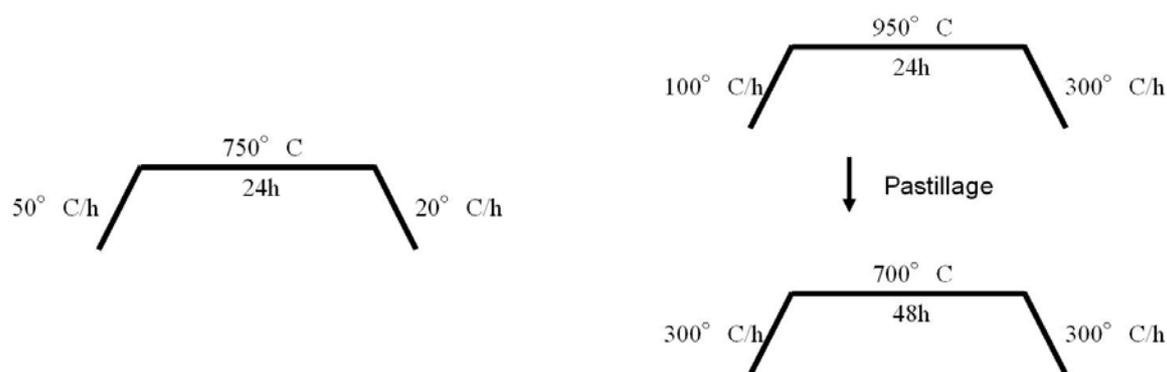
Figure 55 : Profil en température de la synthèse par voie céramique des matériaux  $GeV_4S_8$  (à gauche) et  $GaV_4S_8$  (à droite).
