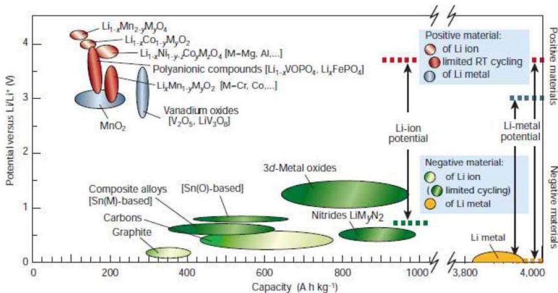
Figure 8 : Capacité et potentiel de fonctionnement de quelques électrodes positives et négatives<sup>[43]</sup>.
