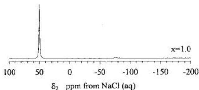
Figure 92 : Spectre  $^{23}Na$  MAS NMR de  $Na_2S$  obtenu à 5.9 T extraite d'une publication de Hwang et al<sup>[21]</sup>.
