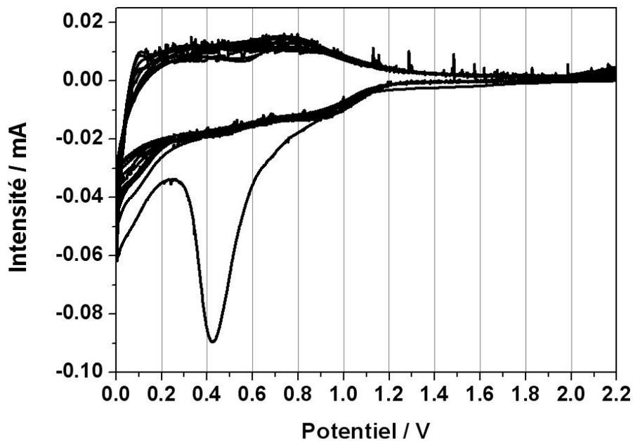
Figure A4 : Voltampérométrie cyclique du Super P Conductive Carbone Black de chez TIMCAL<sup>®</sup> pour une vitesse d'évolution du potentiel de 0,025 mV/s. La masse active de carbone est d'1,5g. La contre-électrode est du sodium métal et l'électrolyte est 1M NaClO<sub>4</sub> dans PC.
