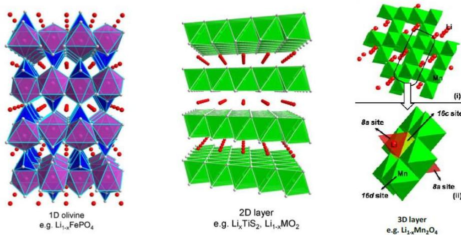
Figure 5 : Représentation de l'insertion du lithium dans les structures 1D type olivine, 2D type lamellaire et 3D type spinelle<sup>[20]</sup>.
