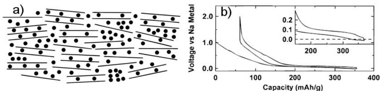
Figure 18 : a) Modèle « house of cards » représentant le remplissage du « hard carbon » par le sodium/lithium<sup>[107]</sup>. b) Profil en potentiel en fonction de la capacité spécifique pour la réaction du glucose pyrolysé avec le sodium. Dans l'encart, un zoom sur la région basse-potential<sup>[107]</sup>.
