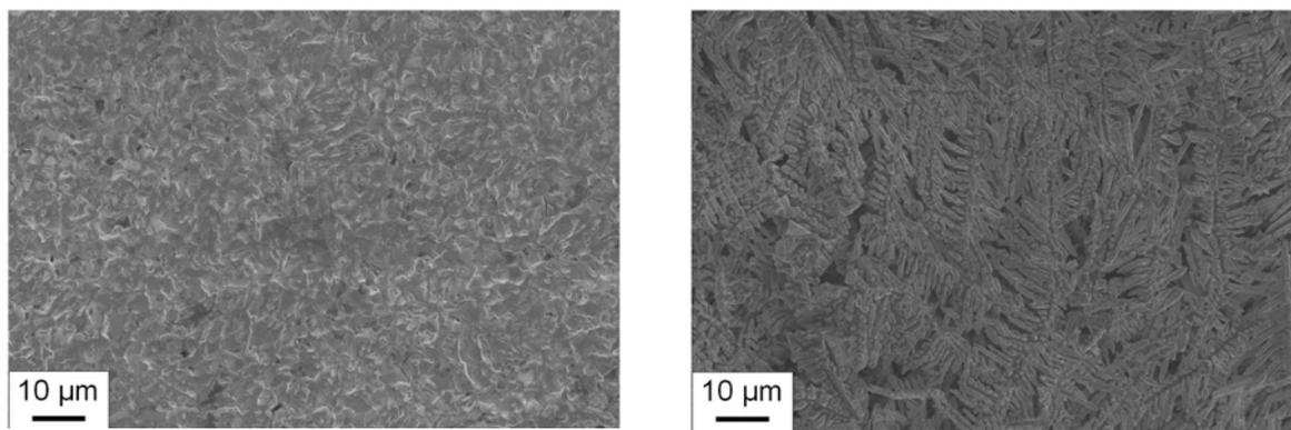
Figure 53 : Clichés MEB d'électrodes ayant été posées dans des demi-piles n'ayant pas cyclé. A gauche, une électrode pulsée, à droite, une électrode non pulsée. L'électrolyte est 1M NaClO<sub>4</sub> dans PC (sans FEC).
