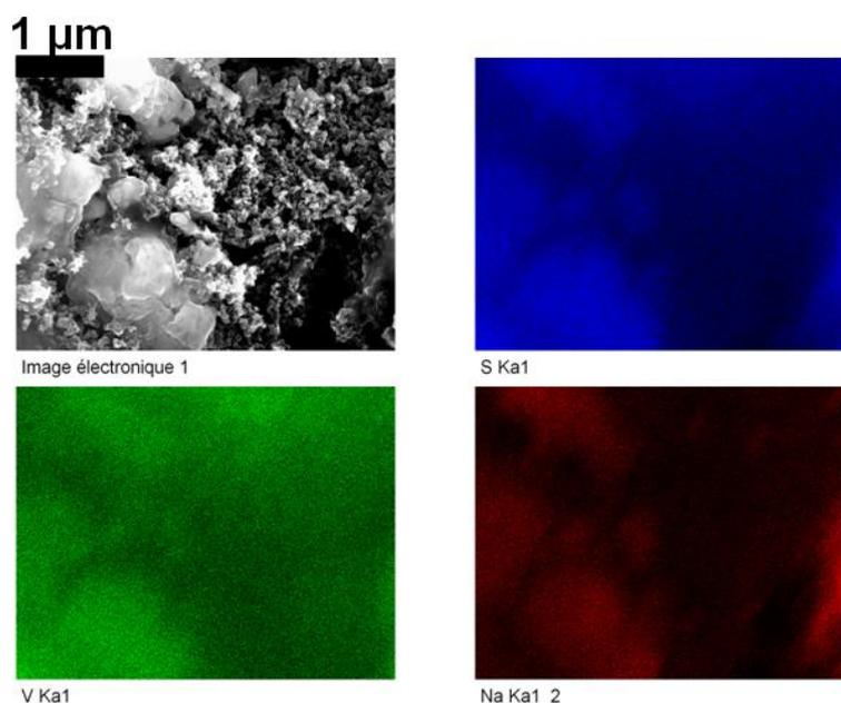
Figure 66 : Cartographie EDX obtenue au MEB d'un échantillon de  $GaV_4S_8$  après une décharge complète. En haut à gauche : l'image originale, en haut à droite une cartographie de l'élément soufre, en bas à gauche, une cartographie de l'élément vanadium et en bas à droite une cartographie de l'élément sodium. L'intensité de la couleur dans l'image est fonction de la proportion en élément.
