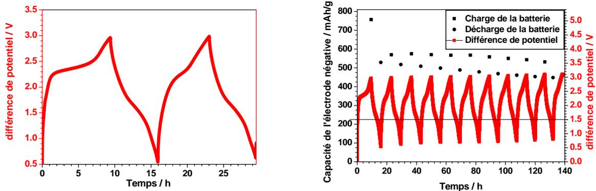
Figure 80 : Tension de cellule de la batterie complète  $GeV_4S_8//NaClO_4(1M)$  dans  $PC//NaFePO_4$  en fonction du temps sur deux cycles complets (à gauche). A droite, la même tension de cellule pour une dizaine de cycles ainsi que la capacité spécifique de l'électrode de travail ( $GeV_4S_8$ ) à chaque fin de charge et de décharge.
