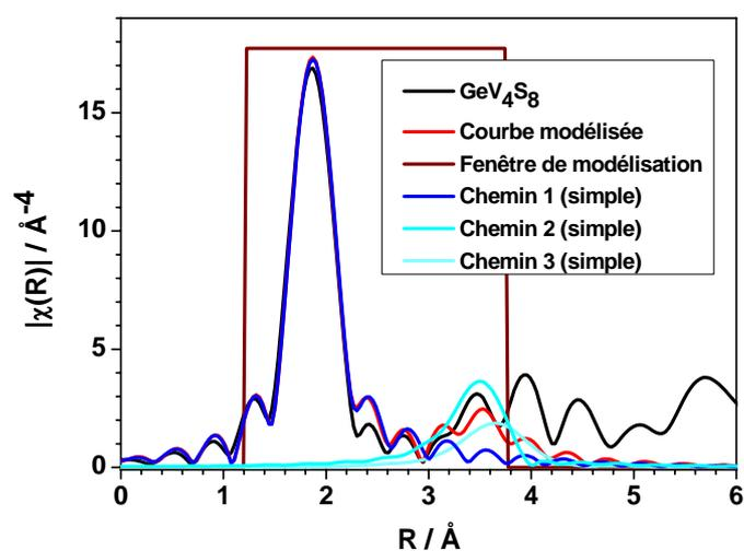
Figure 117 : Fonctions de distributions radiales obtenues pour  $GeV_4S_8$  au seuil K du germanium. La modélisation est également représentée ainsi que les chemins et la fenêtre de  $R$  correspondant à cette modélisation. A droite, les courbes correspondantes dans l'espace des  $k$ .
