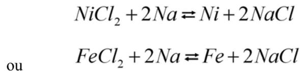
La batterie fonctionnant au chlorure de nickel a une tension de 2,58 V et celle fonctionnant au chlorure de fer a une tension de 2,35 V. La densité d'énergie de ce type de batterie est de 120 W h kg<sup>-1</sup>.
