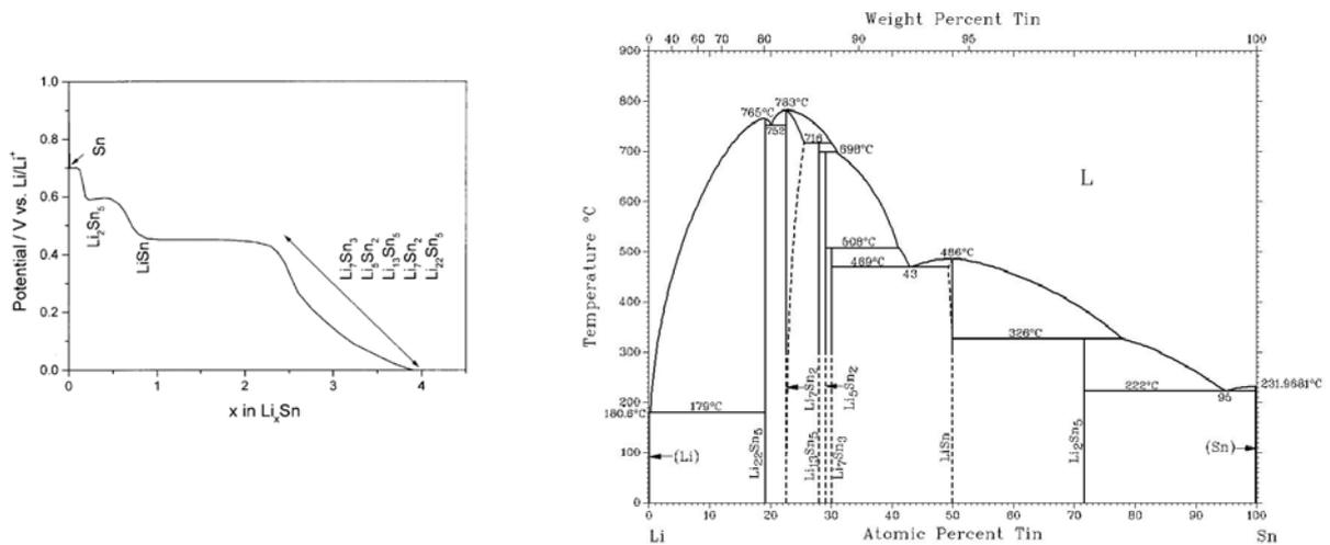
Figure 29 : A gauche, courbe électrochimique représentant la première réaction d'une électrode d'étain dans une demi-batterie avec du lithium en contre-électrode et un électrolyte 1M LiClO<sub>4</sub>/PC<sup>[15]</sup>. A droite, le diagramme de phase Li-Sn.
