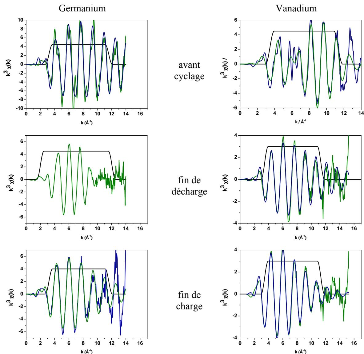
Figure A8 : Figures EXAFS obtenues au seuil k du germanium et du vanadium pour le matériau. De haut en bas : avant cyclage, après la première décharge et après la première charge. En vert est représenté le signal EXAFS, en bleu la modélisation et en noir la fenêtre utilisée. Dans le cas du germanium en décharge, la modélisation n'a pas été concluante. Elle n'est donc pas représentée.
