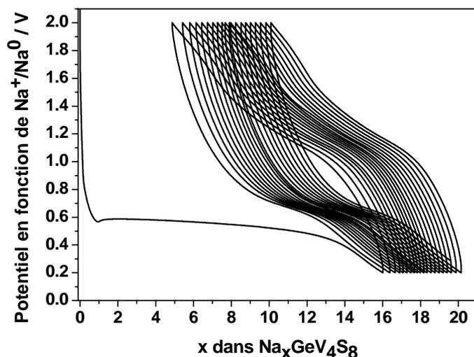
Figure 63 : 20 premiers cycles galvanostatiques pour une cellule  $Na/GeV_4S_8$  déchargée et chargée entre 0,2 et 2,0 V à un régime de  $C/20$  (0,8 sodium en 1 heure).
