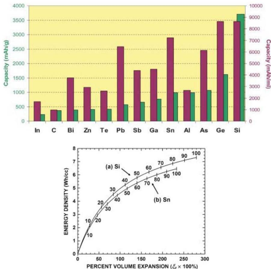
Figure 6 : Capacités volumiques et massiques théoriques de certaines réactions d'alliage comparées à celles du graphite<sup>[29]</sup> (en haut) et densité d'énergie en fonction du pourcentage d'expansion volumique pour le silicium et l'étain (en bas). Sur les courbes sont indiqués les pourcentages par rapport à l'alliage électrochimiquement actif<sup>[30]</sup>.
