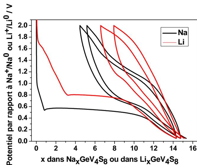
Figure 65 : Courbe typique du potentiel en fonction de la composition en alcalin pour un régime de  $C/20$  (0,8 atomes de sodium ou lithium en 1 heure). Les potentiels de coupure ont été choisis à 0,05 V et 2 V. Le matériau d'électrode positive est  $GeV_4S_8$ . Afin de comparer l'allure des courbes, la courbe correspondant au lithium a été normalisée sur celle correspondant au sodium afin que leur abscisse en fin de première décharge soit la même.
