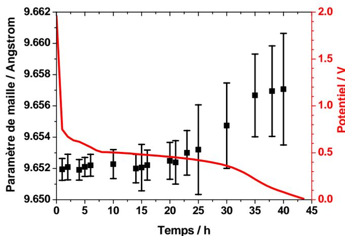
Figure 88 : Paramètres de maille de  $GaV_4S_8$  calculés à partir du traitement en mode Full Pattern Matching pour les diffractogrammes successifs obtenus lors de la diffraction des rayons X *in situ*.
