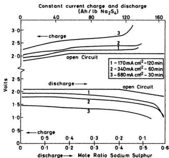
Figure 76 :.Potentiel final en fonction de l'état de décharge pour différents courants de charge et de décharge de la batterie sodium-soufre.<sup>[29]</sup>
