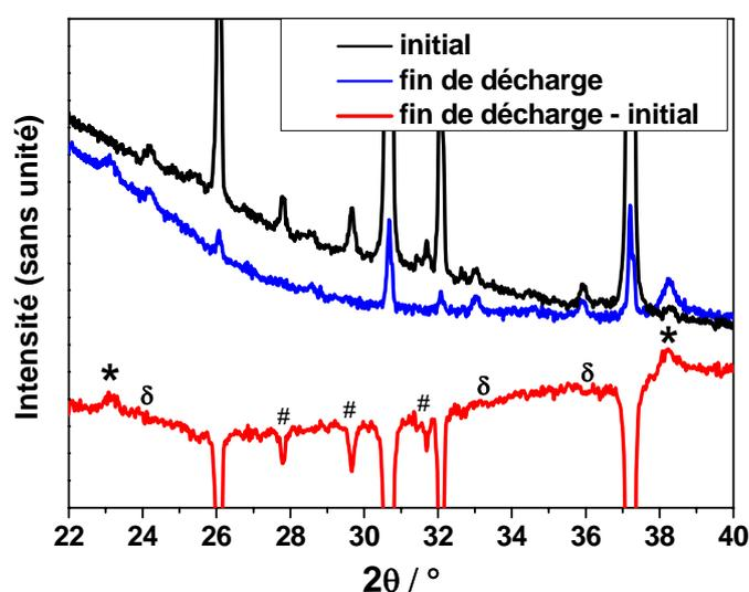
Figure 85 : Diagrammes de diffraction initial, en fin de décharge et leur soustraction pour une batterie  $\text{GaV}_4\text{S}_8/\text{Na}$ .
