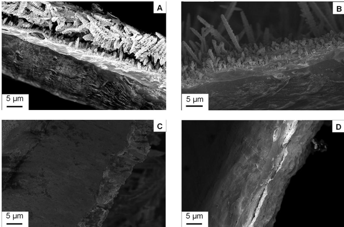
*Figure 40 : épaisseur de la première couche d'étain observée au MEB des 4 types de dépôt utilisés. En A, le 2 minutes non pulsé, en B, le 5 minutes non pulsé, en C, le 10 minutes non pulsé et en D, le 10 minutes pulsé. La couche d'étain se trouve en haut (A,B) ou à droite (C,D) du cliché.*
