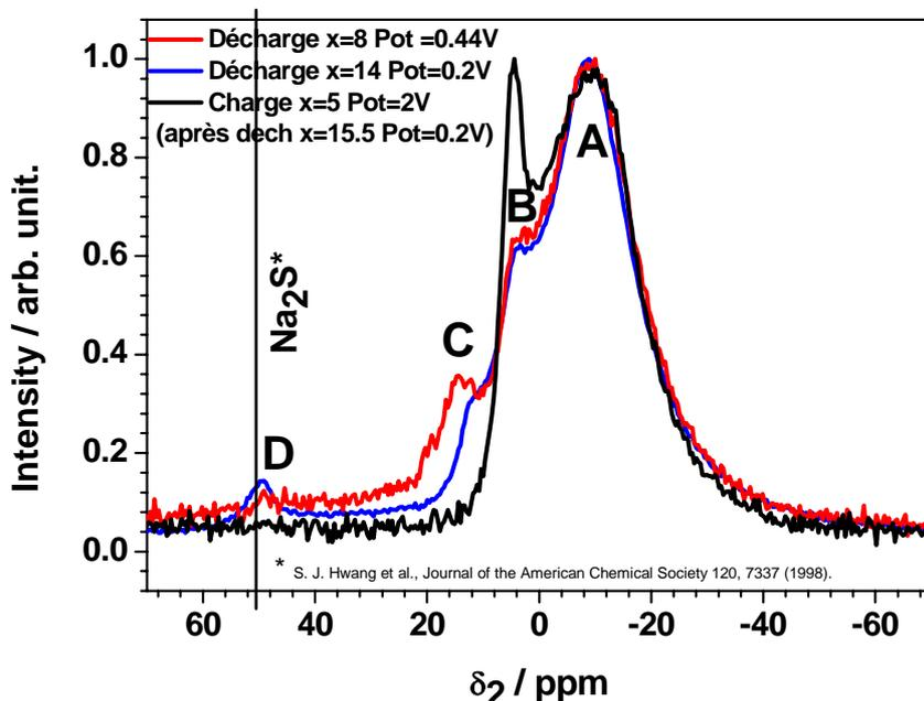
Figure 93 : Spectres de RMN  $^{23}\text{Na}$  MAS obtenus dans des conditions quasi-similaires de plusieurs échantillons de  $\text{GaV}_4\text{S}_8$  ayant subi une partie de cyclage électrochimique en batterie sodium-ion.
