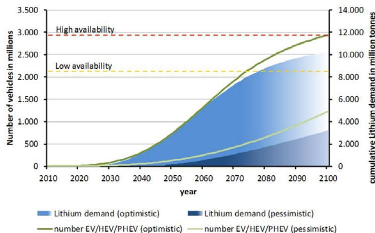
Figure 10: Évaluation de la demande en lithium, de la disponibilité du lithium et du nombre de véhicules électriques en fonction du temps<sup>[47]</sup>.
