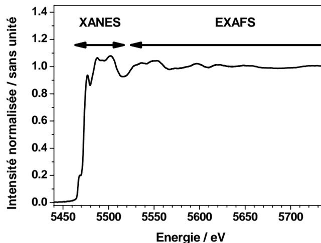
Figure 103 : spectre d'absorption X du composé  $\text{GeV}_4\text{S}_8$  au seuil K du vanadium. Les gammes d'énergie de la partie XANES et de la partie EXAFS y sont représentées.
