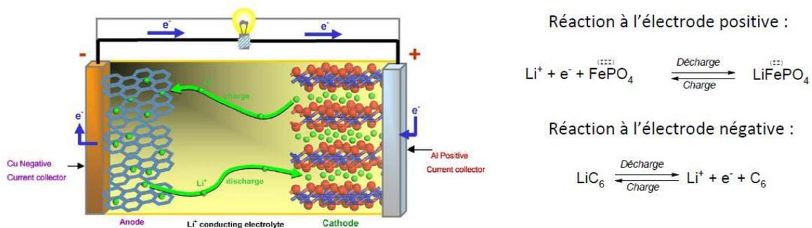
Figure 2 : Fonctionnement d'un accumulateur lithium-ion<sup>[4]</sup>
