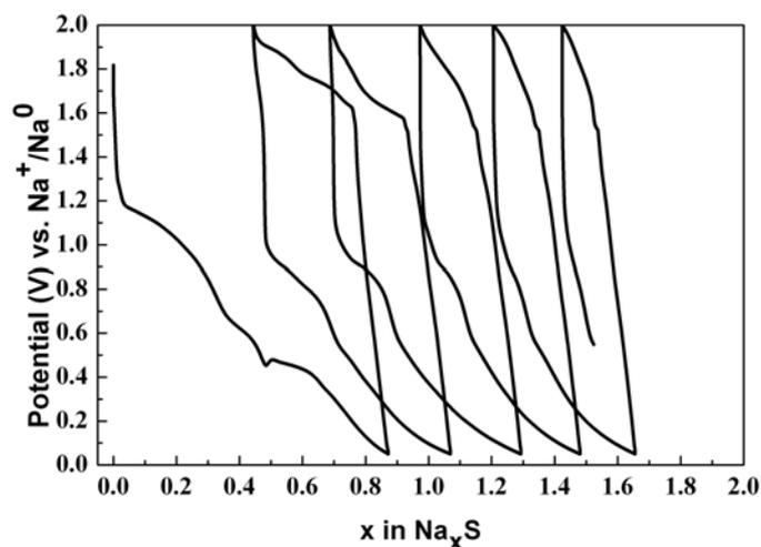
Figure 75 : Courbe de cyclages galvanostatique pour une électrode composite comprenant 75% massiques de soufre, 15% de carbone SP et 10 % de PVDF dans une demi-batterie sodium-ion. Le régime est de C/15 (en se basant sur le composé  $Na_2S$ ) et les potentiels de coupures sont de 0,05 et 2 V.
