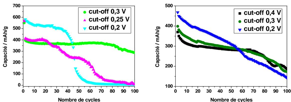
Figure 69 : Capacité en fonction du nombre de cycle pour des électrodes de  $GeV_4S_8$  (à gauche) et de  $GaV_4S_8$  (à droite) testées en batterie sodium-ion à un régime de C/20 (0,8 sodium en 1 heure) dont le potentiel de coupure en réduction a été choisi entre 0,4 et 0,2 V. Le potentiel de coupure en oxydation est de 2V.
