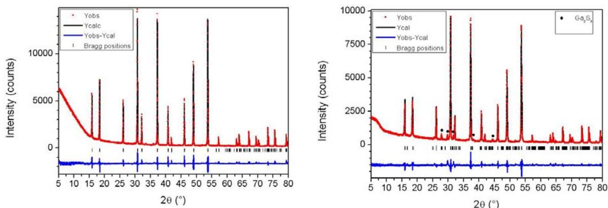
Figure 56 : Diagramme de diffraction des rayons X des poudres de  $\text{GeV}_4\text{S}_8$  (à gauche) et  $\text{GaV}_4\text{S}_8$  (à droite) et Full Pattern Matching associé. Les indexations des deux phases  $\text{AV}_4\text{S}_8$  sont présentées en annexe 3.
