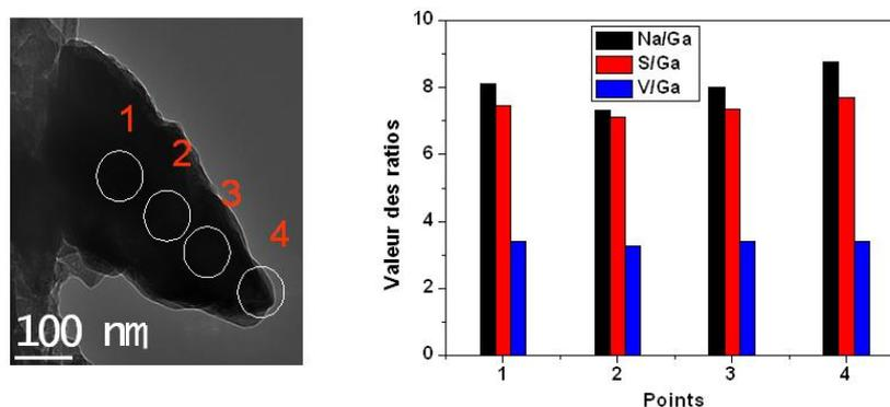
Figure 67 : Ratio élément/gallium de composition obtenu au MET à l'aide d'une sonde EDX du matériau en fin de décharge en différents points dans un grain de  $GaV_4S_8$  et cliché du grain associé.
