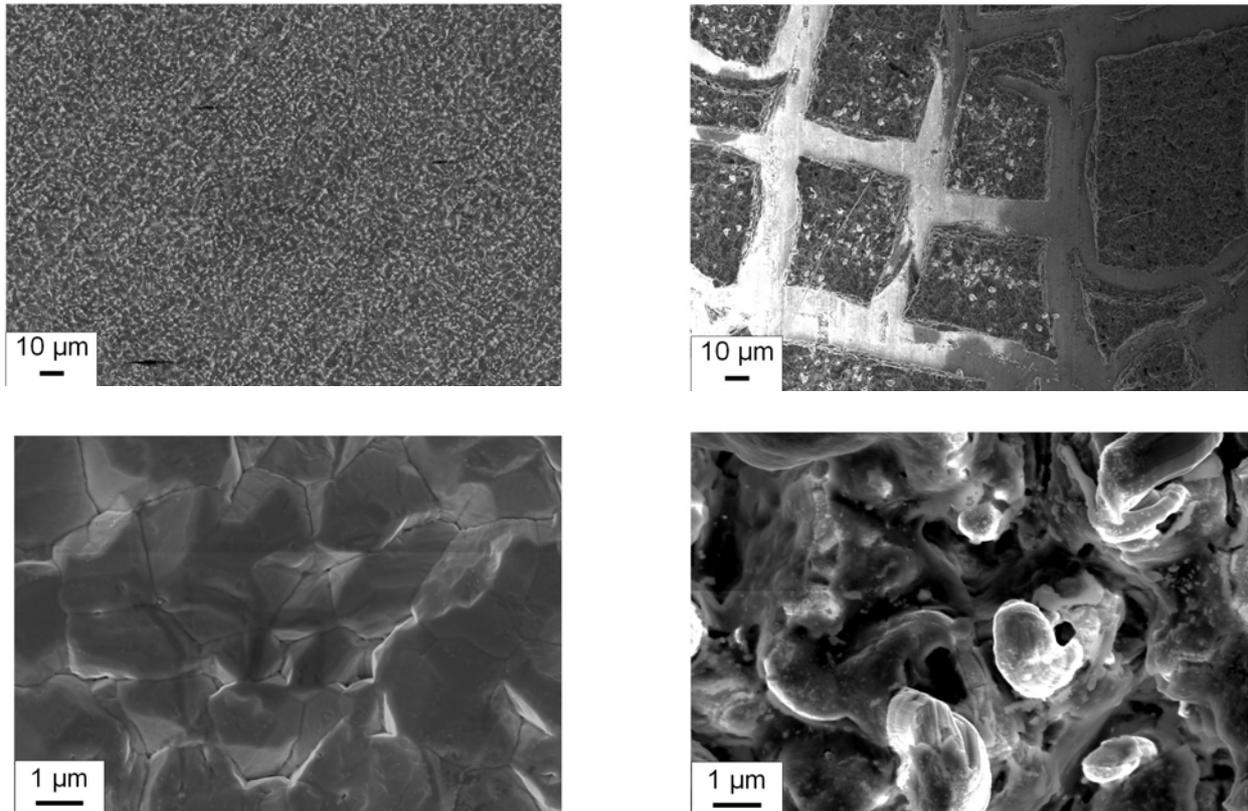
Figure 51 : Clichés MEB d'un échantillon pulsé avant (à gauche) et après (à droite) un cycle en batterie, à différents grossissements. L'électrolyte est 1M NaClO<sub>4</sub> dans PC (sans FEC), le régime est de C/20 (un sodium en 5 heures) et les potentiels de coupure sont de 0,01 et 0,8 V.
