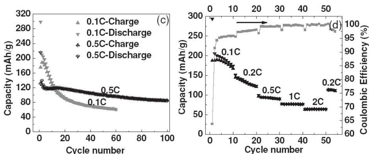
Figure 20 : (c) Performances en cyclage de l'électrode  $\text{Na}_2\text{Ti}_3\text{O}_7$  à une densité de courant de 0,1C et 0,5C. (d) Performance en cyclage de l'électrode  $\text{Na}_2\text{Ti}_3\text{O}_7$  dans une demi-batterie. L'électrolyte est 1M de bis(fluorosulfonyl)imide de sodium (NaFSI) dans PC. Les électrodes composites sont composées à 30% en masse d'acétylène et le liant utilisé est l'alginate de sodium (10%)<sup>[122]</sup>.
