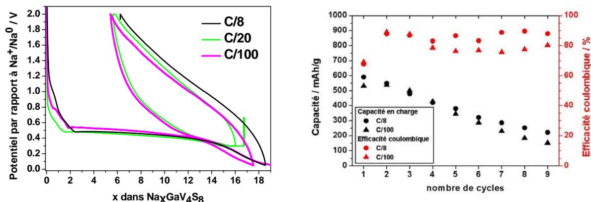
Figure 68 : Courbes galvanostatiques de  $\text{GaV}_4\text{S}_8$  dans des batteries sodium-ion pour différents régimes (à gauche). A droite, capacité et efficacité coulombique en fonction du temps pour des batteries sodium-ion cyclées à différents régimes et pour un potentiel de coupure en réduction de 0,05 V pour les régimes C/8 et C/100 et de 0,3 V pour le régime C/20.
