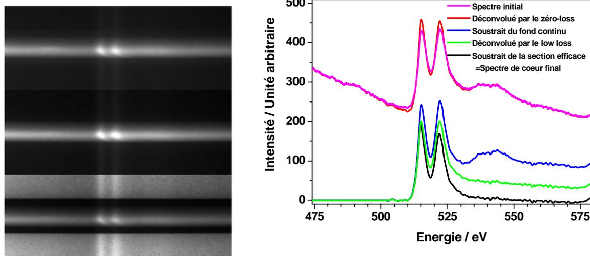
Figure 99 : Les différentes étapes du traitement du spectre des pertes de cœur avec pour exemple  $GaV_4S_8$  au seuil L du vanadium. A gauche, de haut en bas, l'image du spectre brut, corrigé du fond noir, et corrigé du gain. A droite, le même spectre calibré et inséré dans un graphe suivi des spectres après déconvolution par le pic sans perte, soustraction du fond continu, déconvolution des pertes faibles et soustraction de la section efficace.
