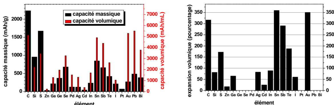
Figure 27 : Capacités spécifiques et volumiques théoriques de différents matériaux d'alliage pour batterie sodium-ion (à gauche). À droite est représentée l'expansion volumique associée à ces capacités. Certaines données sont manquantes car les publications concernant les caractéristiques structurales de l'alliage contenant le plus de sodium ne sont pas disponibles en anglais ou en français.
