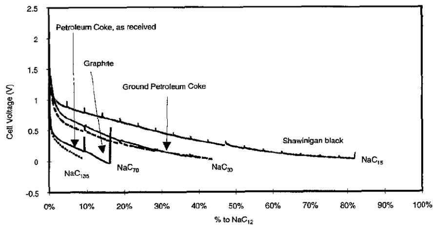
Figure 17 : Comparaison de la décharge de batteries  $\text{Na}/\text{P}(\text{EO})_8\text{NaCF}_3\text{SO}_3/\text{C}$  chauffée à  $86^\circ\text{C}$  en fonction du type de carbone ou de la taille des particules<sup>[102]</sup>.
