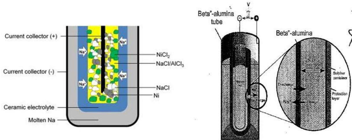
Figure 12 : Représentation schématique d'une batterie Na-NiCl<sub>2</sub> (ZEBRA) en décharge (à gauche) et d'une batterie Na-S (à droite)<sup>[53, 54]</sup>.
