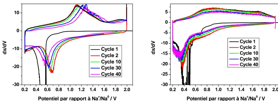
Figure 61 :  $dx/dV$  en fonction du potentiel pour certains des premiers cycles de la cellule  $Na/GeV_4S_8$  (à gauche) ou  $Na/GaV_4S_8$  (à droite) ayant cycle entre 0,2 et 2,0 V à un régime de  $C/20$  (0,8 sodium en 1 heure). Le pic à 0,5 V de la première décharge est tronqué pour des raisons de visibilité du reste de la figure.
