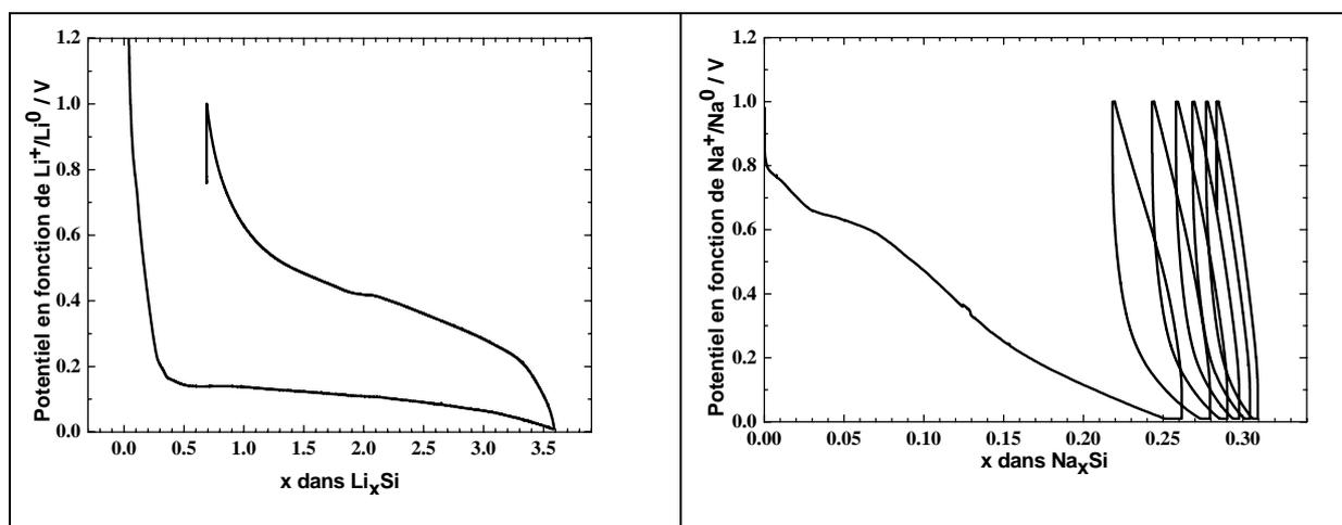
Figure A12 : Courbes galvanostatiques obtenues dans une batterie lithium-métal (C/50, électrolyte : LP30) puis dans une batterie sodium-métal (C/50, électrolyte : NaClO<sub>4</sub> dans PC)
