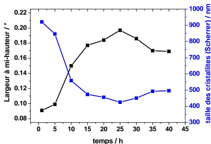
Figure 89 : Largeur à mi-hauteur du pic à  $37^\circ$  pour différents diffractogrammes de  $\text{GaV}_4\text{S}_8$  obtenus à différentes étapes de la décharge. L'échelle de droite indique la taille des cristallites associées calculée à l'aide de la formule de Scherrer.
