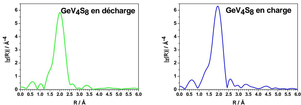
Figure 111 : Fonctions de distributions radiales obtenues par transformées de Fourier des spectres EXAFS des échantillons au  $GeV_4S_8$  en décharge (à gauche) et en charge (à droite) au seuil  $K$  du vanadium.
