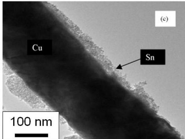
Figure 31 : Cliché MET d'un nanopilier de cuivre recouvert d'étain<sup>[30]</sup>. L'icône-échelle indiquant 100 nm a été ajoutée à l'image originale.
