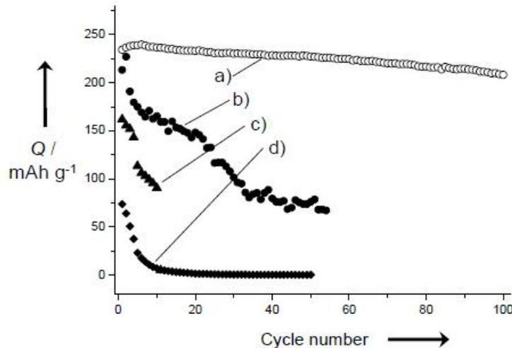
Figure 16 : Capacité en fonction du nombre de cycle de l'oxydation d'une électrode de « hard carbon » pour 1M  $\text{NaClO}_4$  dans le solvant a) PC, b) EC:DMC (1:1), c) PC:DMC (1:1), d) PC:VC(49:1).<sup>[98]</sup>
