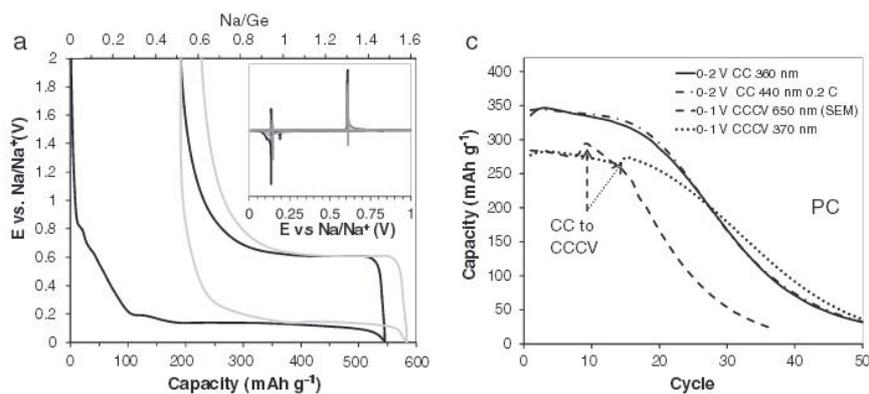
Figure 74 : A gauche, potentiel en fonction de la capacité pour les deux premiers cycles galvanostatiques à  $C/20$  d'une demi-batterie  $Ge/Na$  pour laquelle l'électrode de germanium a été déposée en couche mince. A droite, la capacité obtenue en fonction du nombre de cycle. [28]
