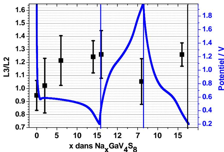
Figure 102 : Ratio des aires des raies L3 et L2 du seuil L du vanadium obtenues par EELS sur des grains de  $GaV_4S_8$  extraits d'une électrode ayant été arrêtée à différents stades de cyclage en fonction du nombre d'atomes de sodium ayant réagi. L'intervalle de confiance à 95% est également représenté. En bleu, la courbe électrochimique du potentiel en fonction du nombre de sodium ayant réagi.
