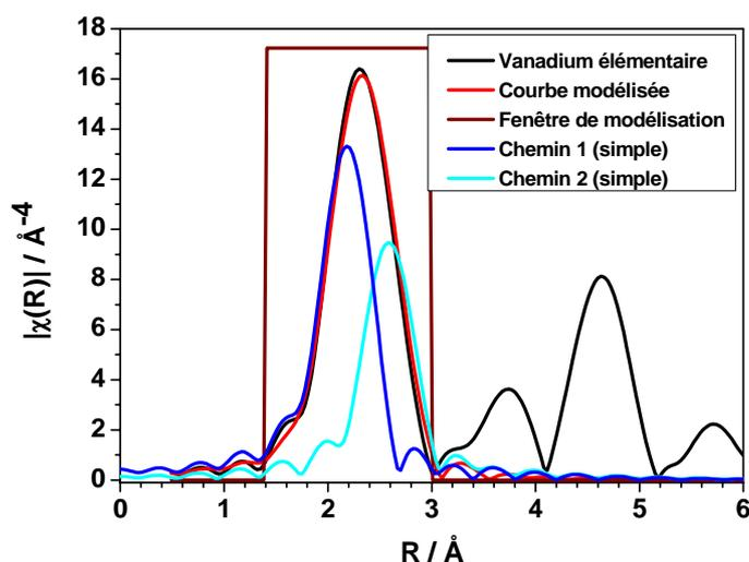
Figure 108 : Fonctions de distributions radiales obtenues pour le vanadium sous sa forme élémentaire. La modélisation est également représentée ainsi que les chemins et la fenêtrage de  $R$  correspondant à cette modélisation.
