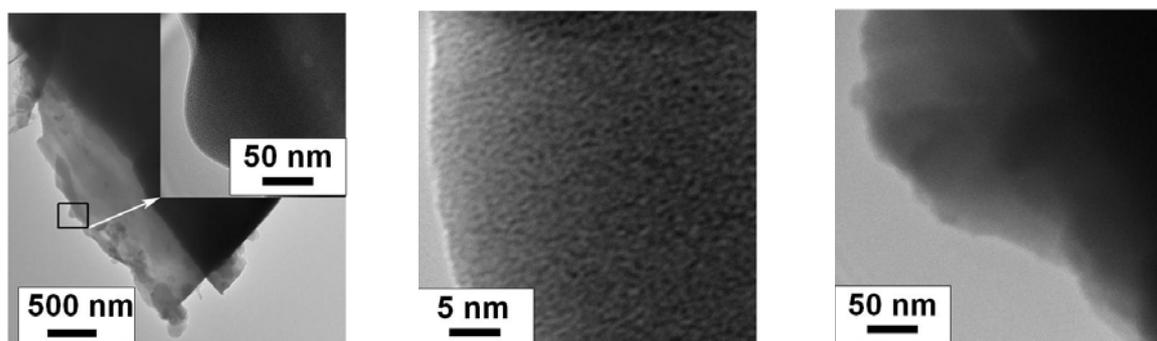
Figure 95 : Clichés de microscopie électronique en transmission de grains de  $GaV_4S_8$  après cyclage en batterie et arrêt à différentes étapes électrochimiques. L'image la plus à gauche et celle du centre correspondent à une vue, à différentes échelles, d'un grain appartenant à une électrode en fin de décharge. L'image la plus à droite correspond à une vue d'un grain appartenant à une électrode dont le cyclage a été arrêté en fin de charge.
