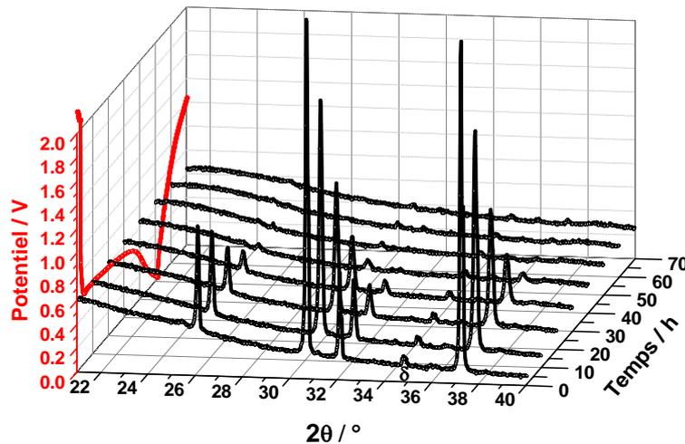
Figure A72 : Diagrammes de diffraction des rayons X collectés durant la première décharge et le début de la première charge pour une cellule électrochimique Na/GeV<sub>4</sub>S<sub>8</sub> déchargée à 0,05V à une vitesse de 1 Na en 3h.
