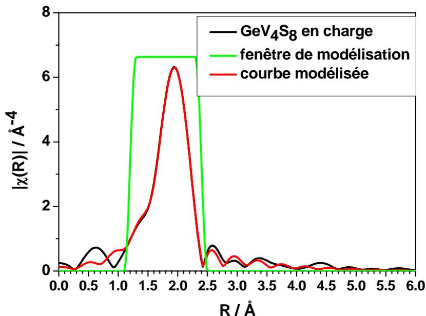
Figure 113: Fonctions de distribution radiale obtenue pour  $GeV_4S_8$  en charge au seuil K du vanadium. La modélisation avec le premier chemin V-S de  $GeV_4S_8$  est également représentée ainsi que la fenêtre de R correspondant à cette modélisation.
