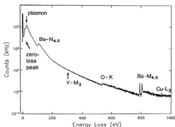
Figure 96 : Spectre de perte d'énergie des électrons de  $YBa_2Cu_3O_7$  avec l'énergie des électrons sur une échelle logarithmique. Ce spectre, pris uniquement à titre d'exemple, permet d'identifier les différentes zones d'énergie d'un spectre obtenu par EELS, à savoir le 0-loss et le plasmon dans la zone des pertes faibles (<50 eV) et les seuils ainsi que la forme de ceux-ci pour la zone des pertes de cœur (>50 eV)<sup>[31]</sup>.
