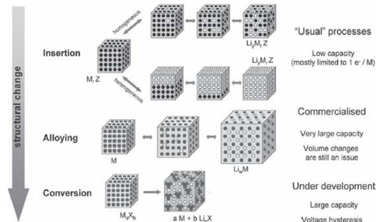
Figure 9 : Illustration schématique du mécanisme de réaction d'électrodes avec les ions lithium dans une batterie lithium-ion<sup>[44]</sup>.
