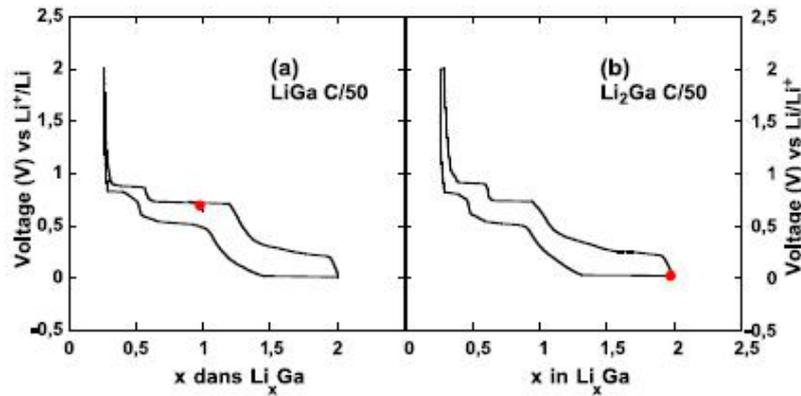
Figure 71 : Courbe typique du potentiel en fonction de l'insertion pour une électrode de  $\text{LiGa}$  (à gauche) et une électrode de  $\text{Li}_2\text{Ga}$  (à droite) dans le cas d'une batterie lithium-ion (Régime C/50, mode potentiostatique)<sup>[24]</sup>.
