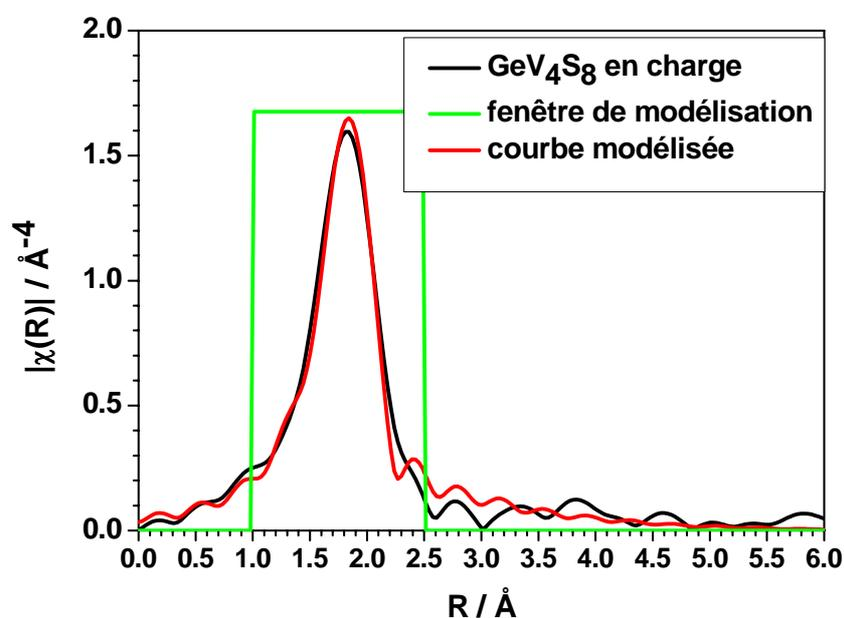
Figure 119 : Fonction de distribution radiale obtenue pour  $\text{GeV}_4\text{S}_8$  en charge au seuil K du germanium. La modélisation avec le premier chemin V-S de  $\text{GeV}_4\text{S}_8$  est également représentée ainsi que la fenêtre de  $R$  correspondant à cette modélisation.
