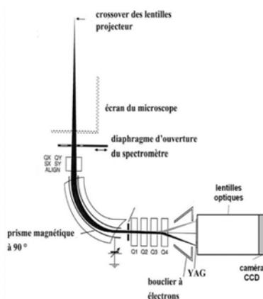
Figure 98 : Schéma du spectromètre GATAN PEELS 666 modifié<sup>[11]</sup>.
