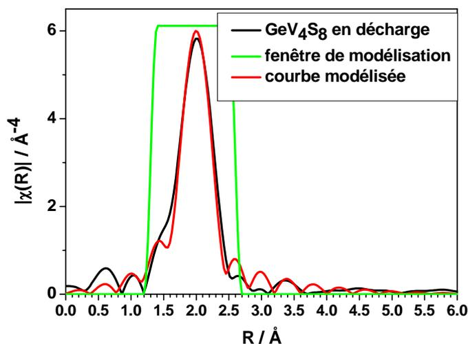
Figure 112 : Fonction de distribution radiale obtenue pour  $GeV_4S_8$  en décharge au seuil K du vanadium. La modélisation est également représentée ainsi que la fenêtre de R correspondant à cette modélisation.
