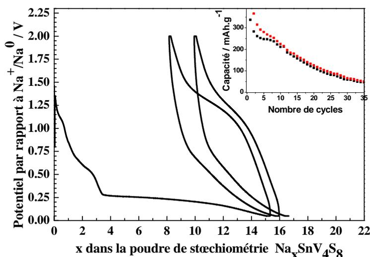
Figure 82 : Courbe typique du potentiel en fonction de la composition pour une cellule  $Na/SnV_4S_8$  déchargée et chargée entre 0,05 et 2,0 V à un régime de  $C/20$  (0,8 sodium en 1 heure). La capacité en charge et en décharge pour la même cellule entre le premier et le trentième cinquième cycle est présentée en encart.
