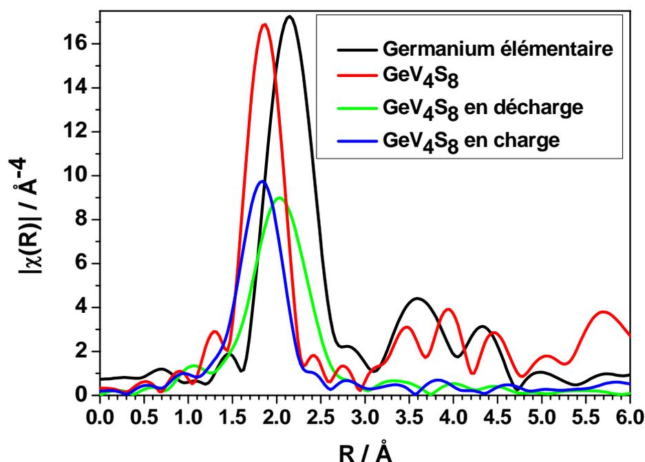
Figure 114 : Fonctions de distributions radiales obtenues par transformées de Fourier des spectres EXAFS des différents échantillons analysés au seuil K du germanium.
