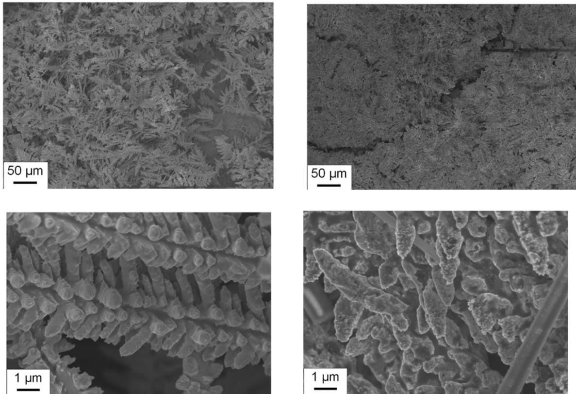
Figure 52 : Clichés MEB d'un échantillon non pulsé avant (à gauche) et après (à droite) un cycle en batterie à différents grossissements. L'électrolyte est 1M NaClO<sub>4</sub> dans PC (sans FEC), le régime est de C/20 (un sodium en 5 heures) et les potentiels de coupure sont de 0,01 et 0,8 V.
