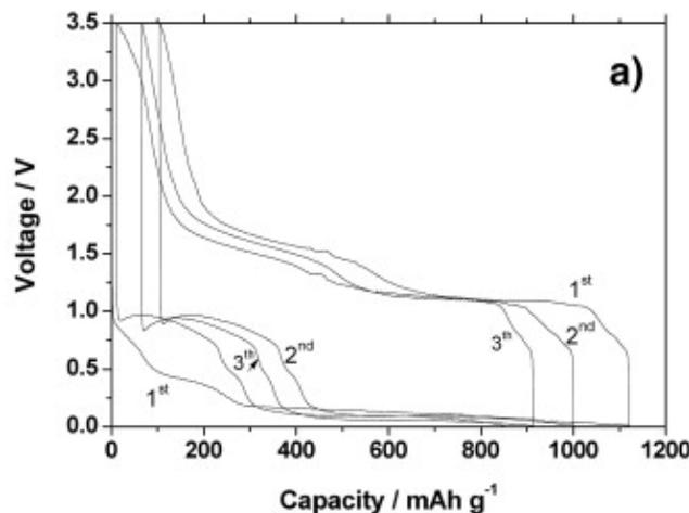
Figure 21 : Courbe galvanostatique d'une cellule  $Sb_2O_4/Na$  à un régime de C/70<sup>[128]</sup>.
