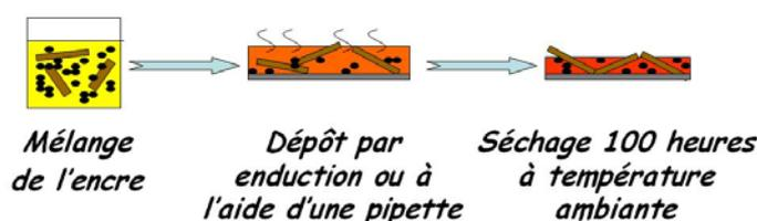
Figure 59 : Schéma de principe de réalisation des électrodes de  $AV_4S_8$ <sup>[18]</sup>.
