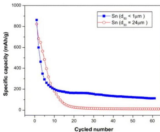
Figure 30 : Capacité en fonction du nombre de cycle pour une batterie Sn/Li avec des particules d'étain de taille nanométrique ou micrométrique à  $0.2 \text{ mA/cm}^2$ <sup>[31]</sup>.
