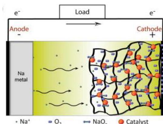
Figure 13 : Représentation schématique d'une batterie sodium-air en décharge<sup>[64]</sup>.
