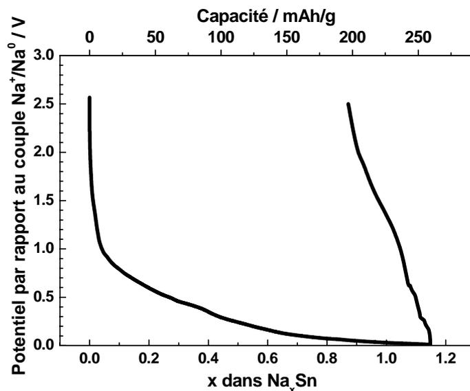
Figure 44 : Premier cycle galvanostatique pour une électrode de type dendritique (temps de dépôt : 10 min) à un régime de  $C/25$  (0,15 atomes de sodium par heure).
