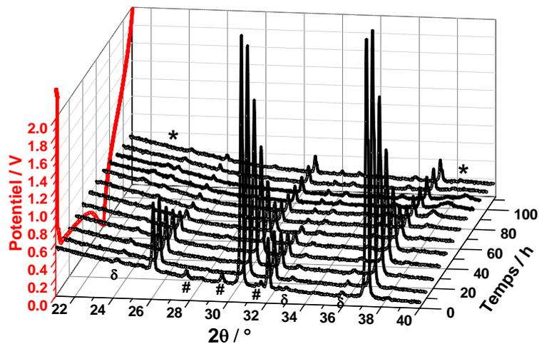
Figure A71 : Diagrammes de diffraction des rayons X collectés durant le premier cycle pour une cellule électrochimique Na/GaV<sub>4</sub>S<sub>8</sub> déchargée à 0,05V à une vitesse de 1 Na en 5h.
