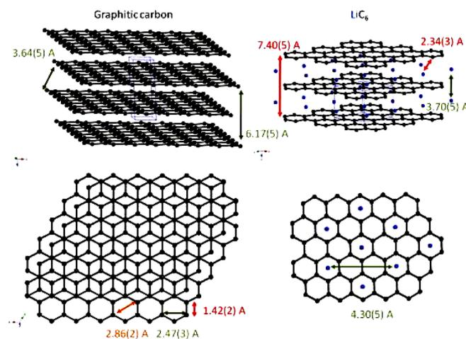
Figure 4 : Fragment de la structure cristallographique du graphite (gauche) et de  $\text{LiC}_6$  (droite) en vue latérale et vue de dessus. Plusieurs distances interatomiques sont également représentées.<sup>[9]</sup>
