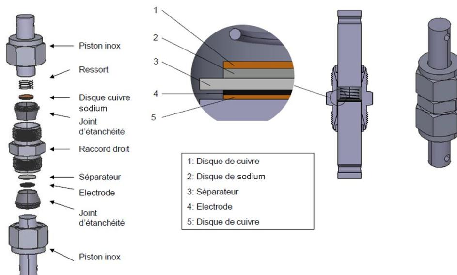
Figure 43 : schéma d'un montage Swagelok<sup>[5]</sup>.
