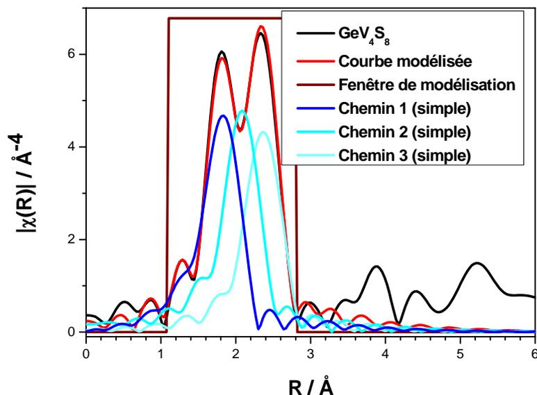
Figure 110 : Fonctions de distributions radiales obtenues pour  $GeV_4S_8$  au seuil K du vanadium. La modélisation est également représentée ainsi que les chemins et la fenêtre de R correspondant à cette modélisation.
