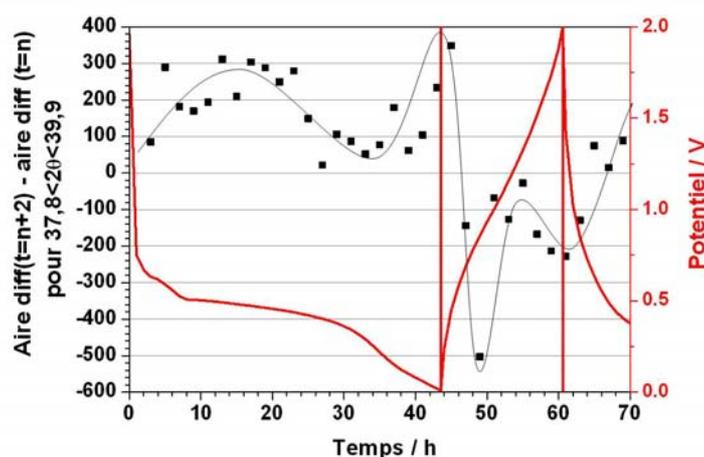
Figure 86 : Potentiel en fonction du temps d'une même batterie ayant cyclée à un régime de C/40 (décharge en 40 heures) et valeur de la soustraction des aires obtenus sous les diffractogrammes successifs pour  $36^\circ < 2\theta < 40^\circ$ .
