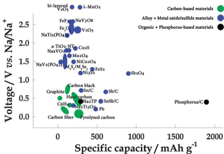
Figure 25 : Potentiel en fonction de la capacité massique pour des matériaux d'électrodes négatives pour batteries sodium-ion<sup>[145]</sup>.
