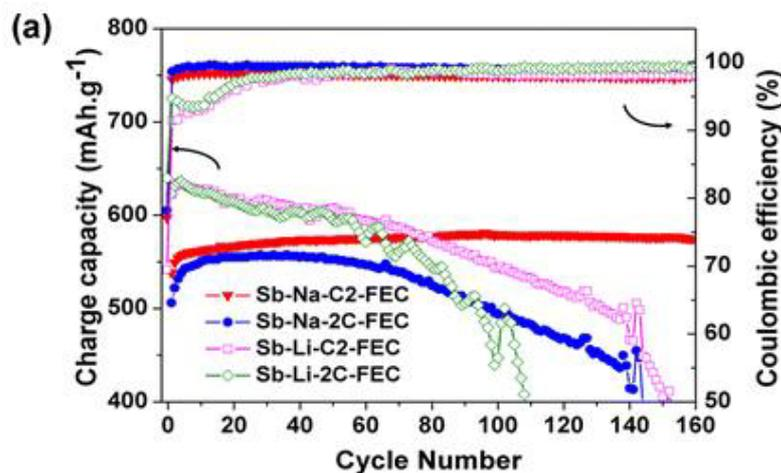
Figure 23 : Performances en cyclage d'une électrode d'antimoine en fonction de  $\text{Na}^+$  et  $\text{Li}^+$  à C/2 et 2C. L'électrolyte est 1 M  $\text{NaClO}_4$  dans PC avec en additif 5% de FEC<sup>[69]</sup>.
