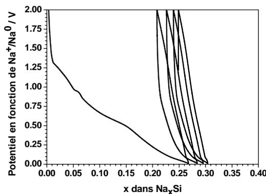
Figure A11 : Courbes galvanostatiques obtenues pour une électrode de silicium en batterie sodium-métal. L'électrolyte utilisé est 1M NaClO<sub>4</sub> dans le PC et la fenêtre de potentiel est 0-2V. L'électrode est composée à 80% de silicium nanométrique, à 12% de carbone et à 8% de CMC. Le régime est de C/50 et la masse de matière active de l'électrode est de 0,76 mg.
