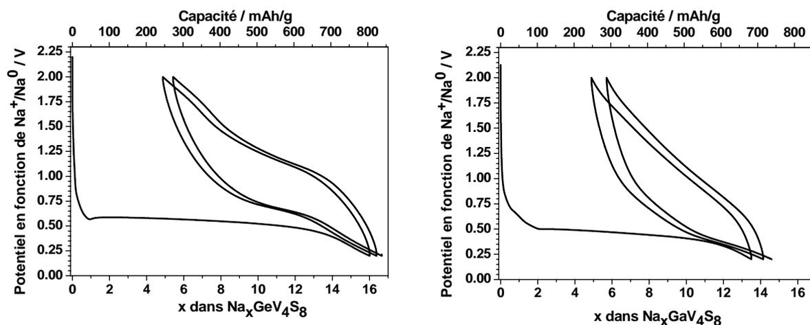
Figure 60 : Courbe typique du potentiel en fonction de la composition pour une cellule  $\text{Na//GeV}_4\text{S}_8$  (à gauche) et pour une cellule  $\text{Na//GaV}_4\text{S}_8$  (à droite) déchargée et chargée entre 0,2 et 2,0 V à un régime de  $C/20$  (0,8 sodium en 1 heure).
