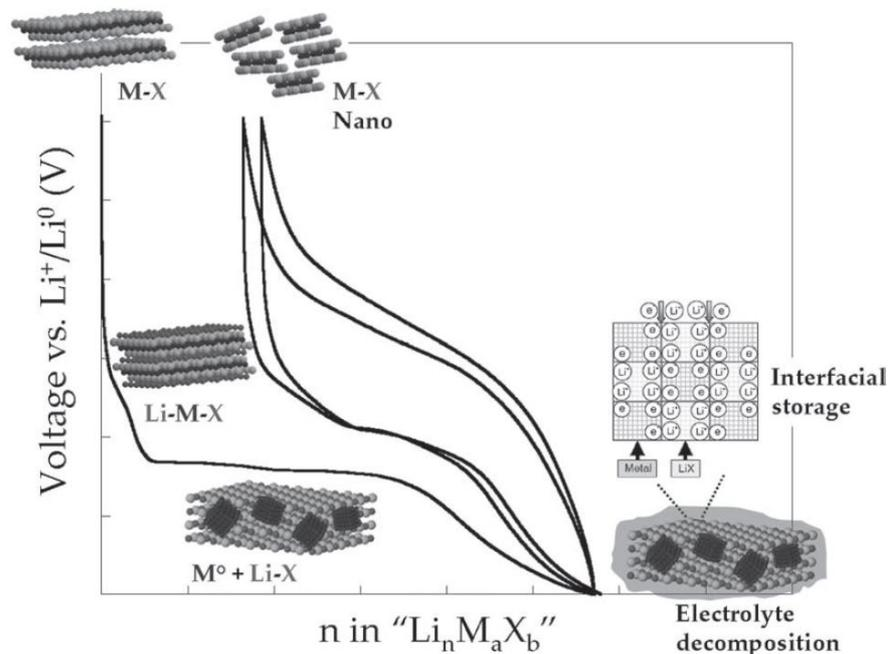
Figure 7 : Courbe typique du potentiel en fonction de la composition pour les deux premiers cycles d'un matériau d'électrode qui réagit à travers un mécanisme de conversion<sup>[40]</sup>.
