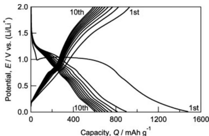
Figure 77 : Profil de potentiel d'une électrode  $Ga_2S_3$  en batterie lithium-ion entre le premier et le dixième cycle<sup>[22]</sup>.
