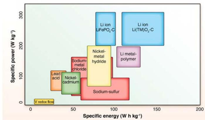
Figure 3 : Diagramme de Ragone - comparaison en puissance et en énergie de différents accumulateurs électrochimiques<sup>[7]</sup>
