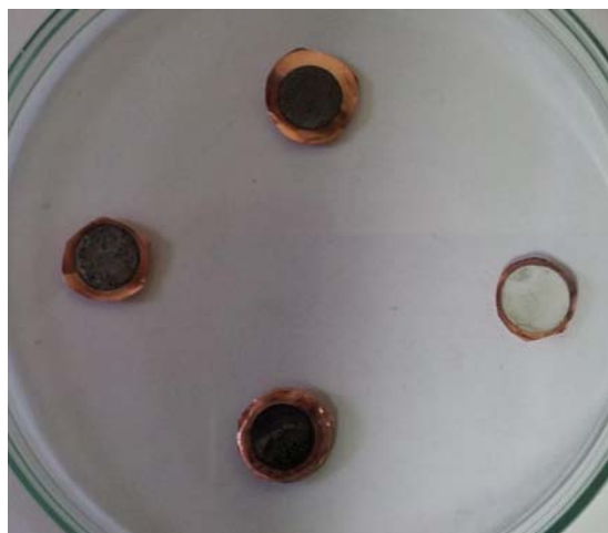
Figure 37 : cliché des électrodes après dépôt d'étain. En haut : 2 min, 15 mA. A gauche : 5 min, 15 mA. En bas : 10 min, 15 mA. A droite, dépôt pulsé de 10 min, (2ms à 15 mA, 8ms 0 mA).
