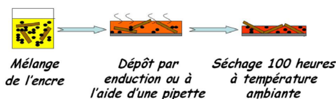
Figure 59 : Schéma de principe de réalisation des électrodes de AV_4S_8 [18] .
