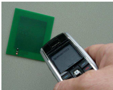
FIGURE 1.20 – Rectenna alimentant une LED, le téléphone GSM (1800 MHz) émettant à une puissance crête d'1 W (d'après [75])
