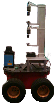
FIGURE 3.3 – Le robot mobile utilisé comme plateforme de test (vue de profil). La potence supportant le système de vision est portée par un châssis équipé de quatre roues motrices.
