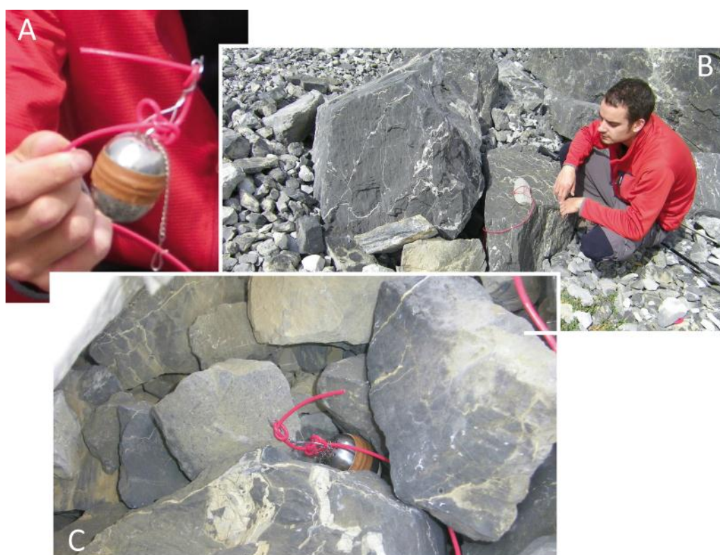
Figure 7-2. Instrumentation d'un site à l'aide d'un thermobouton. A. "Boule à thé" scellée et reliée à un fil B. Aperçu des conditions d'implantation du thermobouton C. Thermobouton posé en subsurface
