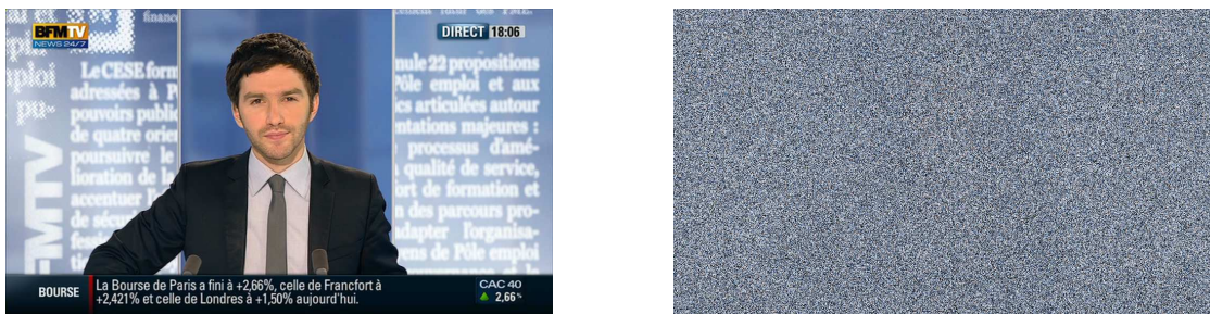
FIGURE 2.6 – Exemple d'images produisant des histogramme de couleur identiques, mais des spatiogrammes différents. L'image de droite a été obtenue en mélangeant les pixels de l'image de gauche.
