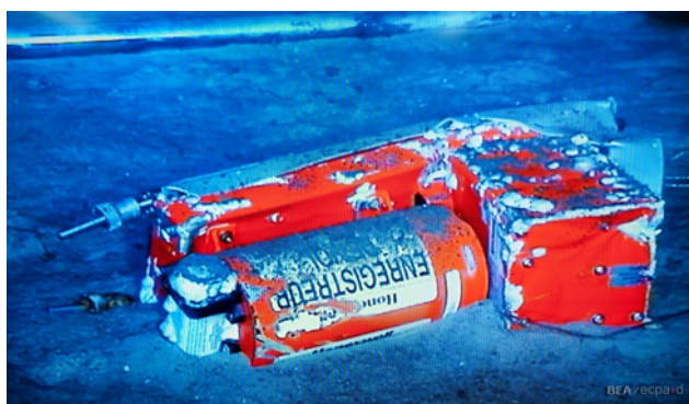
FIGURE 1 – Boîte noire (enregistreur photonique) du vol AF447 (Source : BEA)
