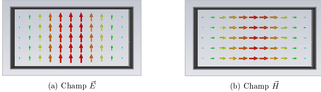
FIGURE 1.8 – Représentation des champs \vec{E} et \vec{H} du mode fondamental TE_{10} dans une coupe du guide rectangulaire (simulation CST MicroWave Studio)
