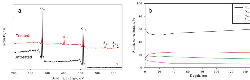
Figure 46. (a) Spectre XPS (1) cellulose de papier P2 témoin et (2) P2 imprégné AEAPMDMS (uptake 12 %). (b) Profil de concentration pour P2 imprégné AEAPMDMS (uptake 12 %) (Extrait de RCL 26)
