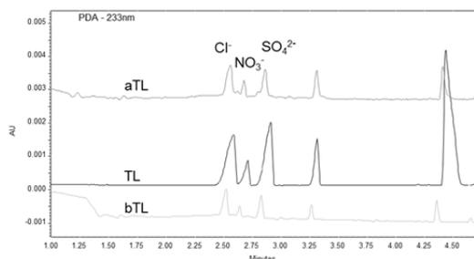
Figure 9. Electrophérogrammes (CE/PDA) dans les extraits aqueux de ligne brune et de papier. Conditions CE: capillaire 75 μm × 61 cm (L<sub>eff</sub>=50,4 cm), Electrolyte CEofix Anions5 pH 5,4 (Beckman), injection hydrodynamique 0,7 psi 4,5 s, ddp 30 kV, 25 °C, détection 233 nm (Extrait de RCL 25)
