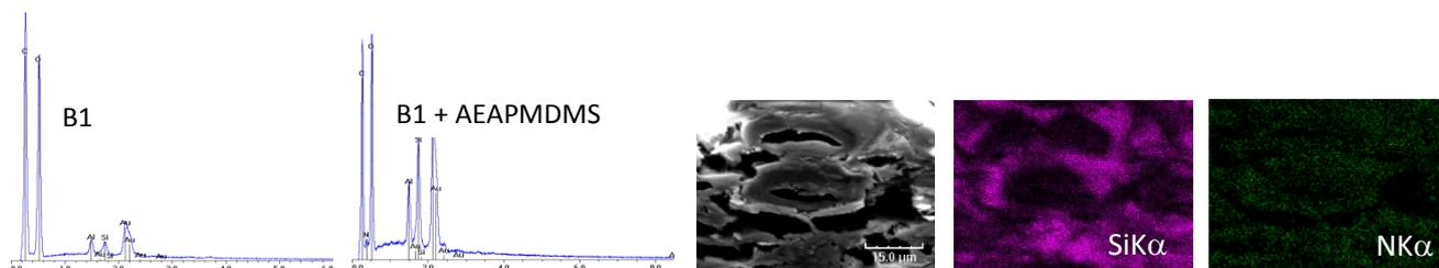
Figure 45. Gauche. Spectres EDS de la surface d'une feuille de papier du livre B1 (1923, mélange de pâte mécanique et de pâte chimique blanchie de résineux, pH = 5,3). Droite. Image MEB d'une coupe transversale dans une feuille de B1 traité AEAPMDMS et cartographies atomique Si et N (Extrait de RCL 26)
