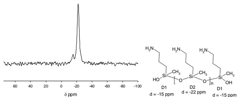
Figure 43. Spectre  $^{29}\text{Si}$  CP MAS-NMR à température ambiante de P2 traité avec AMDES. Le pic vers -15 ppm est attribué à un D1 Si, lié à un seul groupe  $-\text{O}-\text{Si}$  (atome Si terminal). Le pic à -22 ppm correspond à un D2 Si (atome Si lié à deux groupes  $-\text{O}-\text{Si}$ ). L'absence de pic à -4 ppm, correspondant au Si des monomères AMDES, confirme une polymérisation totale (Extrait de RCL 21)
