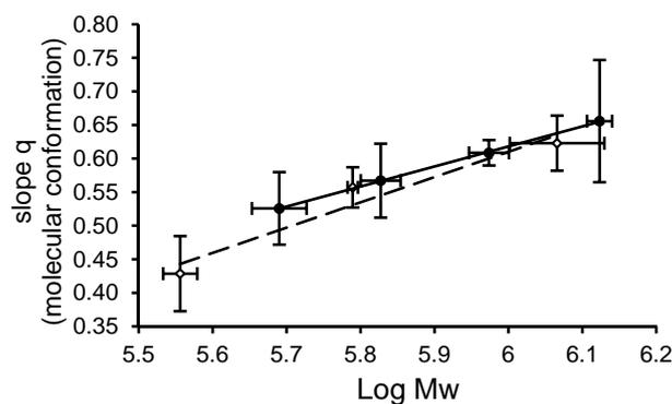
Figure 2. (●)  $q$  en fonction de  $\log M_w$  sur 4 fractions d'élution de 0,5 mL sur la région du pic chromatographique entre 17 et 19 mL; (◇)  $q$  en fonction de  $\log M_w$  sur 3 fractions d'élution recouvrant tout le pic (15-22 mL) (Extrait de RCL 10)
