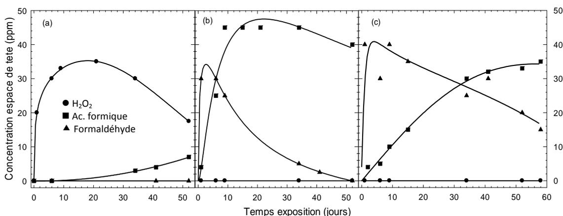
Figure 36. Evolution de la concentration de composés volatils dans les dessiccateurs contenant (a) 30% H<sub>2</sub>O<sub>2</sub> + NaCl (HR 75 %) avec W1; (b) 30 % H<sub>2</sub>O<sub>2</sub> + 4% formaldéhyde + NaCl (RH 75 %), avec W1; (c) 30 % H<sub>2</sub>O<sub>2</sub> + 4 % formaldéhyde (HR 100 %), sans W1. Le taux de conversion du formaldéhyde en acide formique est plus important en présence de W1, ce qui indique le rôle d'une chimie de surface ou de dégradation (Extrait de RCL 28)
