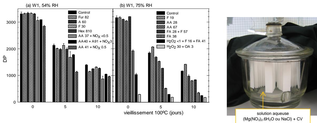
Figure 34. Gauche. Degré de polymérisation DP ( $DP_w$  ou  $DP_v$ ) pour W1 exposé 52 jours aux composés volatils listés dans le tableau 8 à 54 % RH (a) et à 75 % RH (b). Droite. Dessiccateur d'exposition aux composés volatils avec papiers suspendus (Extrait de RCL28)
