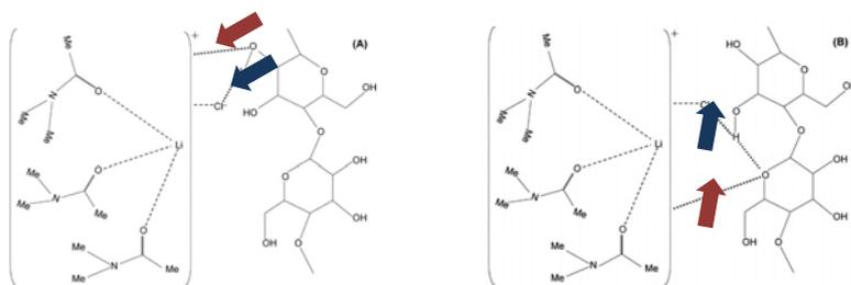
Figure 6. Modèle de Striegel de complexation de la cellulose avec LiCl/DMAc.<sup>13</sup> (A) interaction entre Cl<sup>-</sup> et -OH(C3) en bleu et entre le macrocation et -OH(C2) en rouge ; (B) interaction entre Cl<sup>-</sup> et -OH(C3) en bleu et entre le macrocation et O-cyclique en rouge
