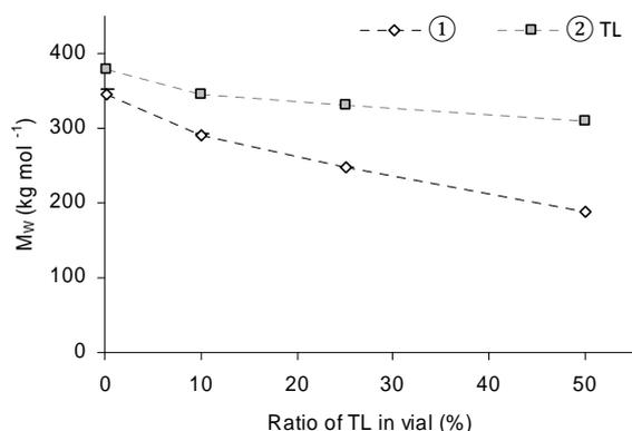
Figure 13.  $M_w$  (kg mol<sup>-1</sup>) des zones ① et ② TL suite à un vieillissement de 5 jours. Les proportions relatives ② TL/① sont 0 (vieillissement B), 0,25 % (vieillissement A), 10 %, 25 % et 50 % (vieillissements C) (Extrait de RCL 25)
