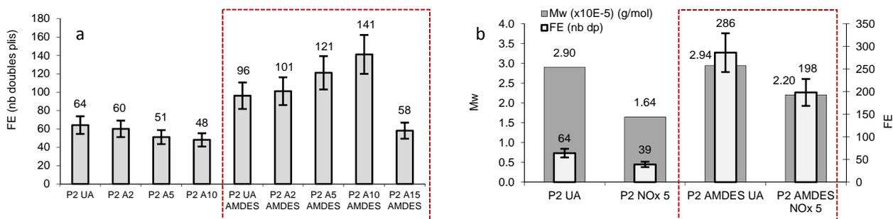
Figure 39. (a) Résistance au double pli (Folding Endurance, FE) de P2 témoin et vieilli à 100 °C (ASTM D6819-02e2) puis traité AMDES 10 % (en poids). (b)  $M_w$  et FE de P2 témoin et P2 traité AMDES 10 % avant (UA) et après exposition pendant 5 jours à 50 ppm NO<sub>2</sub> à 23 °C, 50 % HR (ASTM D6833-02E01) (Graphiques refaits à partir des données dans RCL 20)
