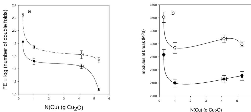
Figure 47. (a) Résistance aux doubles plis (FE) et (b) module de rupture en fonction de l'oxydation (indiquée par la valeur de l'indice de cuivre, NCu) pour P2 témoin et P2 oxydé NaClO (●) avant traitement AMDES et (○) après traitement AMDES. Les uptakes et autres caractéristiques des papiers se trouvent dans le tableau 9 (Extrait de RCL 21)
