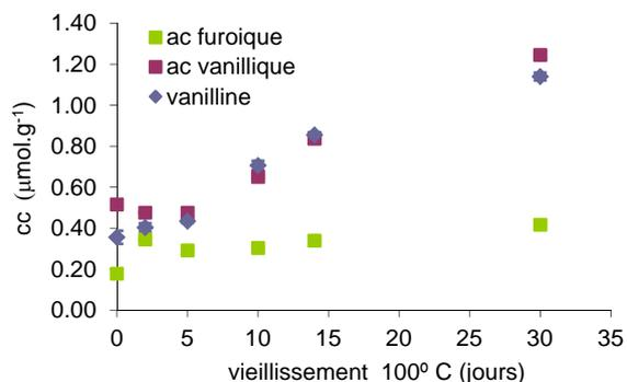
Figure 22. Concentrations en vanilline, acide vanillique et acide furoïque ( $\mu\text{moles par gramme de papier}$ ) en fonction du vieillissement pour P3. Conditions CE/PDA : capillaire  $75 \mu\text{m} \times 60,3 \text{ cm}$  ( $l=50,3 \text{ cm}$ ), BGE borate 50mM pH 9.1, injection hydrodynamique 0,7 psi 4,5 s, ddp +25 kV, 25 °C, détection 325, 242 et 210 nm (Données non publiées)
