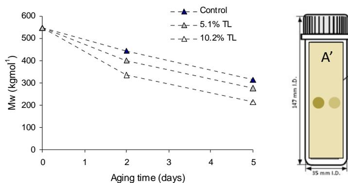
Figure 11. Gauche.  $M_w$  ( $\text{kg mol}^{-1}$ ) de la cellulose en fonction du temps de vieillissement du papier W en système (A') dans les zones où des gouttes d'extraits aqueux de TL ont été déposées (Control = zone témoin). Droite. Schéma du tube de vieillissement contenant la feuille de papier enroulée où ont été déposés les extraits aqueux de ligne brune concentrés à 5,1 % et 10,2 % (poids de l'extrait/poids papier) (Extrait de RCL 25)
