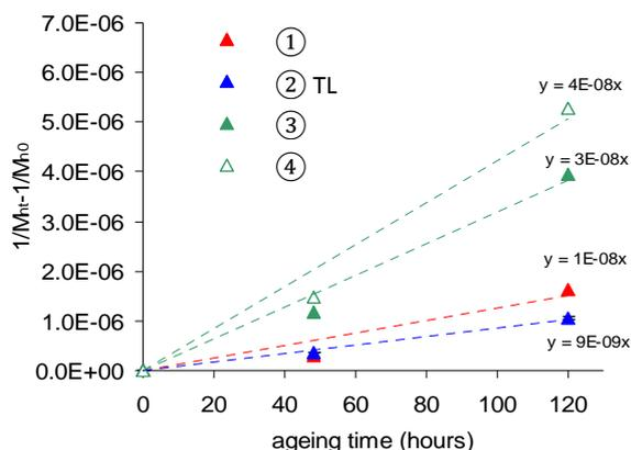
Figure 12.  $(1/M_{nt} - 1/M_{nt0})$  en fonction du temps de vieillissement à 100 °C pour chaque zone du papier (vieillissement B) et constante de clivage des liaisons glycosidiques  $k'$  (= y, pente de la droite)
