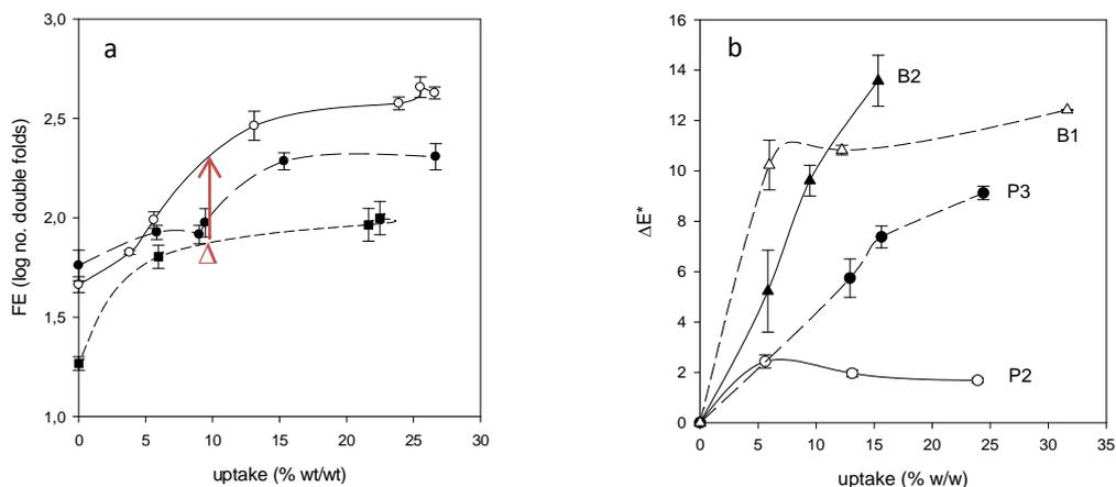
Figure 48. (a) Résistance au double pli (FE) en fonction de l'uptake en AEAPMDMS pour P2 (○), P3 (●) et B1 (■) (1923, mélange de pâte mécanique et de pâte chimique blanchie de résineux, pH = 5,3). (Δ) Représente la valeur de FE pour P2 traité AMDES à uptake identique. (b)  $\Delta E^*_{ab}$  en fonction de l'uptake en AEAPMDMS pour P2 (○), P3 (●), B1 (■) et B2 (□) (1946, 100 % pâte thermomécanique ou chimicothermomécanique, pH = 4,7) (Extrait de RCL 26)
