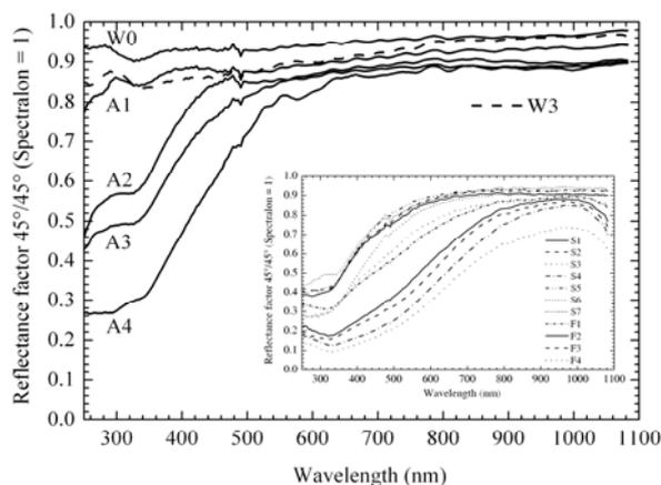
Figure 5. Spectres de réflectance de papier Whatman No.1 non encollé (W0) et encollé à la colle de parchemin (A1-A4) préparée selon une recette traditionnelle.<sup>9</sup> A1 : non vieilli, A2 : vieilli 21 jours à 80 °C 65% HR, A3 : vieilli 21 jours à 90 °C/ 80 % HR, A4 : vieilli 40 jours à 90 °C/80 % HR. W3 : non encollé et vieilli 21 jours à 90 °C et 80 % HR. Dans l'encadré, les spectres d'échantillons de papiers anciens du XV<sup>e</sup> siècle (datés 1413 et 1430) (Extrait de RCL 13)
