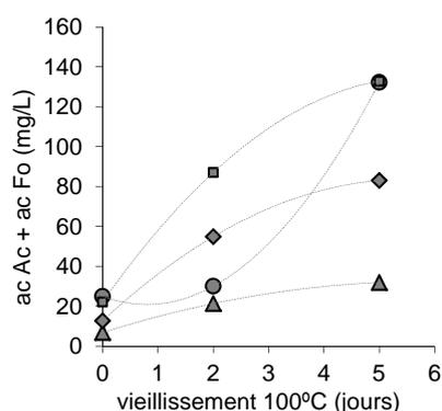
Figure 20. Concentrations dans les extraits aqueux des acides formique et acétique ( $\text{mg L}^{-1}$ ) produits au vieillissement à  $100\text{ °C}$  (ASTM D6819-02e2) pour FA (●), PDP (■), OC (▲) et PB (◆) (tableau 3) (Extrait de RCL 15)
