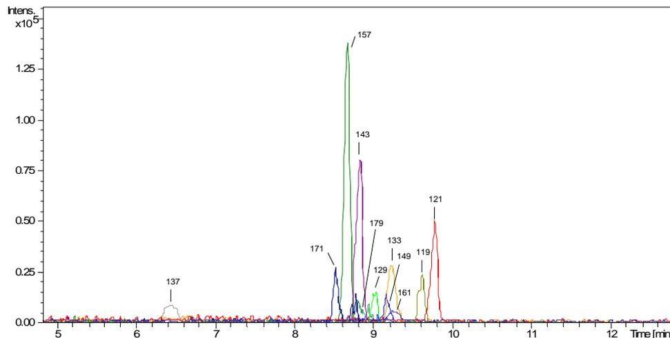
Figure 50. EIE (Extracted Ion Electropherogram) CE/ESI-MS(-) (Méthode B) d'un extrait aqueux de lignes brunes. Attributions,  $m/z$  179 : hexose (glucose),  $m/z$  149 : pentose (arabinose),  $m/z$  143 : acide gluconique  $\delta$ -lactone (?),  $m/z$  133 : acide malique (?),  $m/z$  121 : 4-hydroxybenzaldéhyde,  $m/z$  119 : acide 2-hydroxymalonique (?). Conditions CE et MS voir fig. 24 (Données non publiées)
