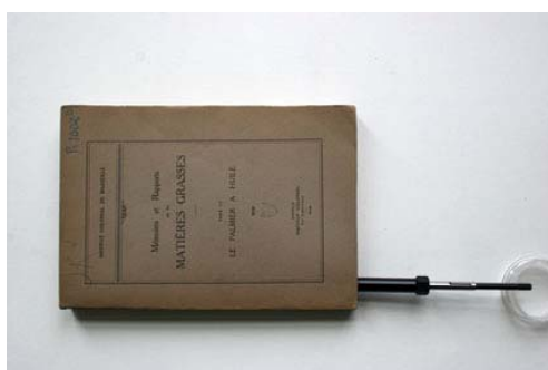
Figure 28. Ouvrage (1928) (collection MNHN) et fibre SPME insérée entre ses pages (cliché A.-L Dupont)
