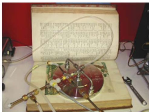
Figure 29. Cellule d'émission FLEC (CSTB) placée sur l'Herbarium, E. Blackwell, 1717 (collection MNHN) (cliché O. Ramalho)
