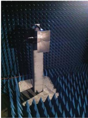
FIGURE B.2 – Positionneur de l'antenne de référence.
