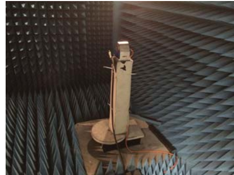
FIGURE B.3 – Positionneur de l'antenne sous test.
