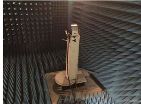
FIGURE B.3 – Positionneur de l'antenne sous test.
