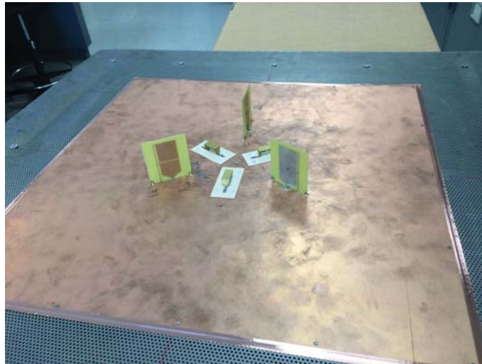
FIGURE IV.45 – Réalisation de l'antenne vectorielle UHF bibande.
