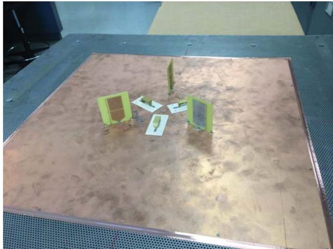
FIGURE IV.45 – Réalisation de l'antenne vectorielle UHF bibande.
