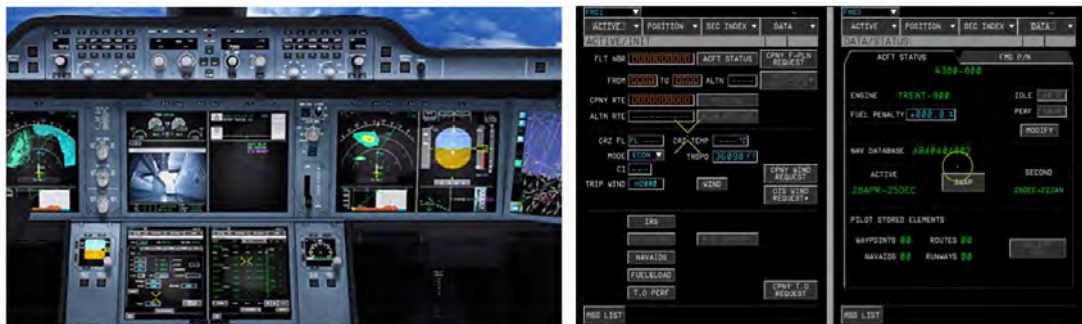
Figure 147 : Interfaces graphiques multi-écrans pour l'aéronautique, cockpit de l'A350 (à gauche), détail de deux pages MFD (Multi Functionnal Display) affichant un ensemble de widgets (à droite).
