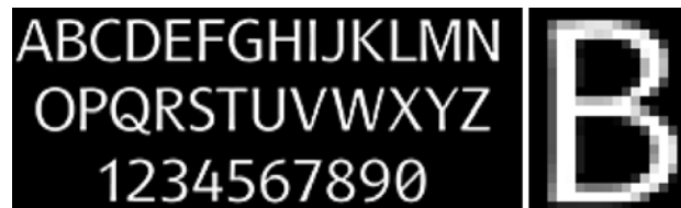
Figure 57 : Jeu bitmap de glyphes des caractères alphanumériques rastérisés pour une hauteur capitale de 19 pixels, détail du « B » (à droite).
