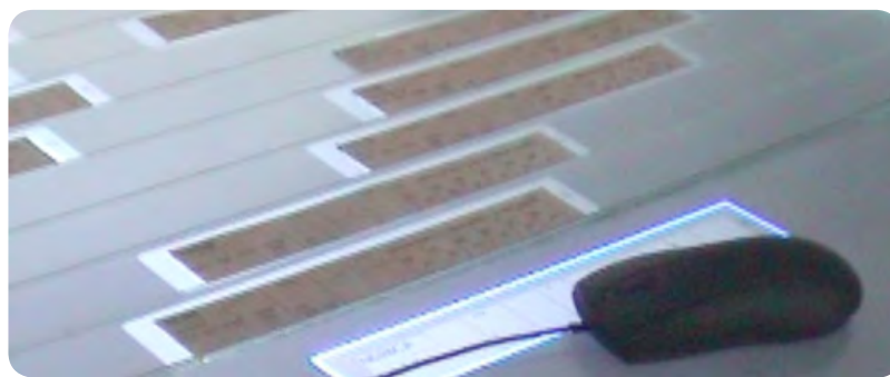
Figure 123 : Affichage d'un strip virtuel «informationnel» au bas du tableau de strips, correspondant à un vol non directement en responsabilité des contrôleurs de la position
