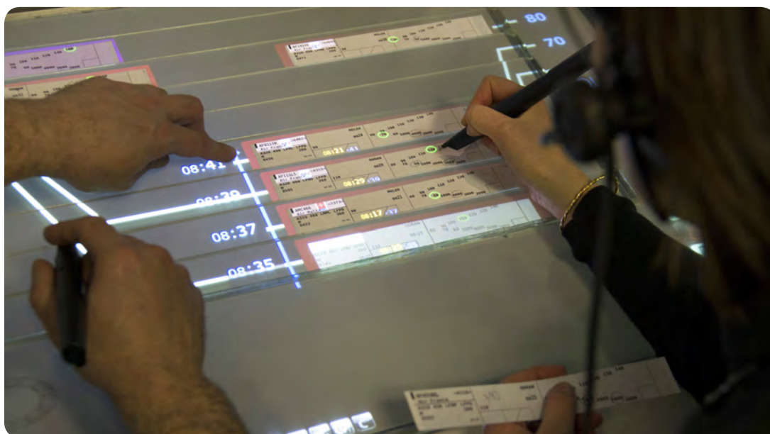
Figure 113 : Le calcul tangible d'une séquence d'heures de sortie (HAP) de stacks
