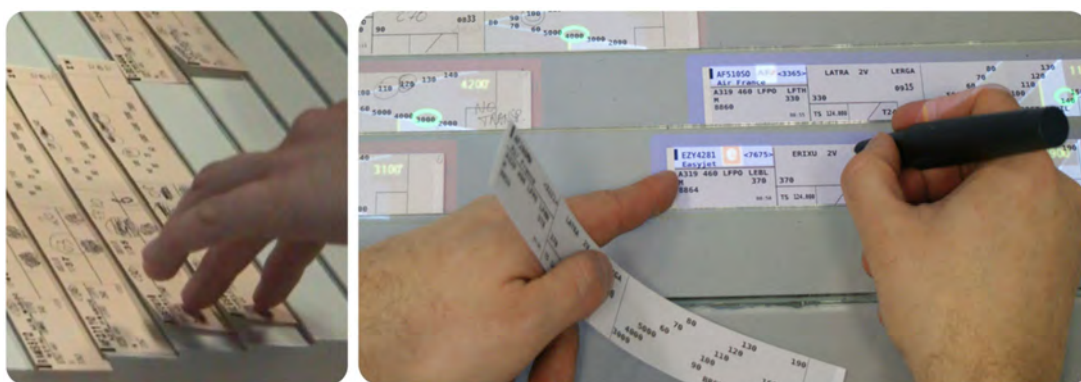
Figure 117 : Le strip papier, un support physique souple spécialement adapté pour la manipulation et pour l'écriture
