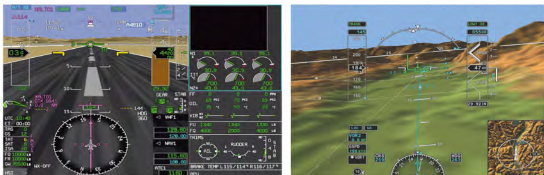
Figure 148 : Interfaces SVS pour le cockpit : vue synthétique 3D du système SVS du Falcon 900 (à gauche), système SVS Primus Epic 2.0 d'Honeywell pour le cockpit des programmes Gulfstream et Falcon (à droite).
