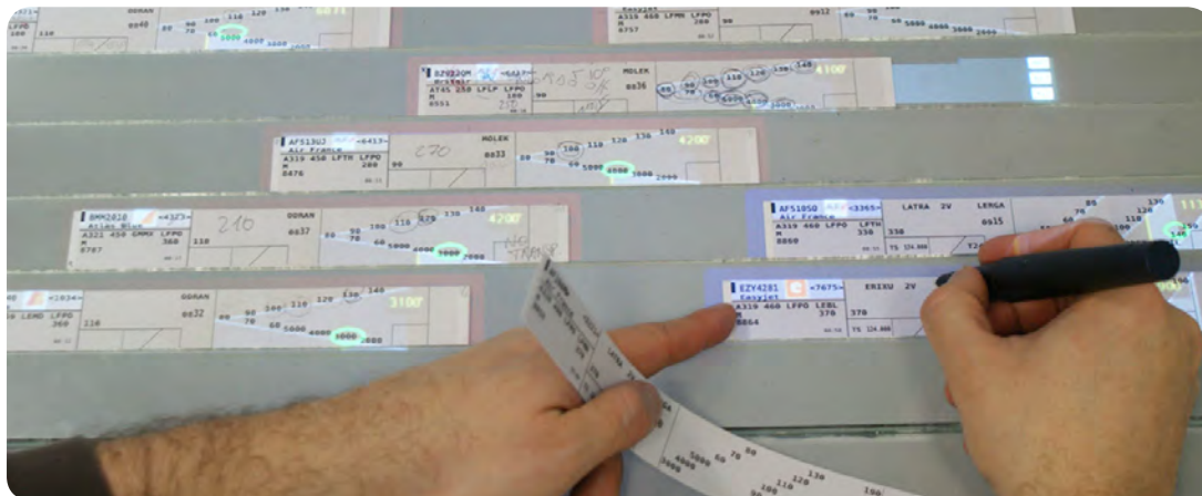
Figure 108 : Le tableau des strips de Strip'TIC, un Window Manager aux vues mixtes physiques et numériques contrôlées par la partie physique de l'objet
