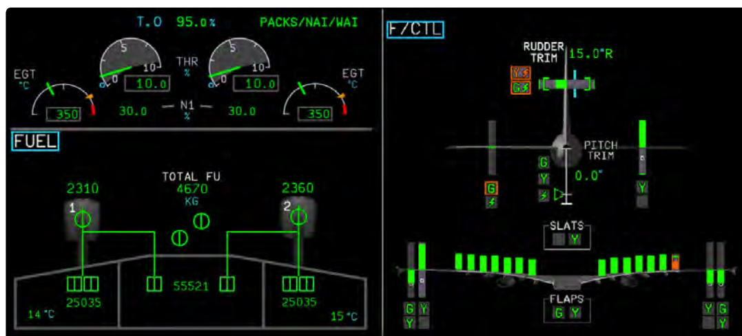
Figure 23 : Représentations schématiques des systèmes avion de l'interface SD
