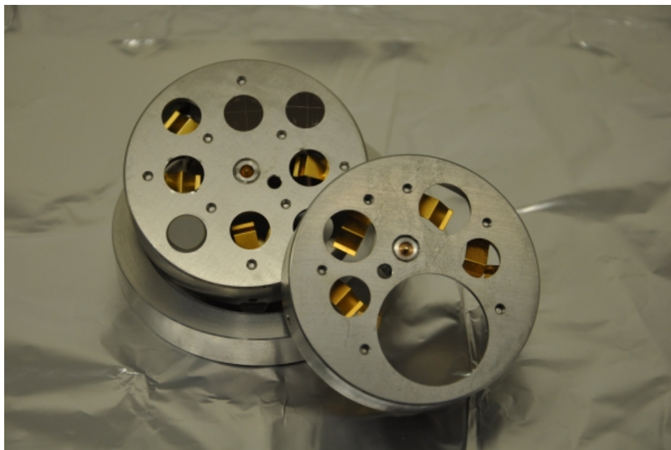
FIGURE 4.4 – Exemple de deux portes échantillons : BIOLOGY à gauche et GEOLOGY à droite. Le porte échantillon BIOLOGY comporte 8 sections de 1 cm de diamètre, utilisé pour les échantillons lunaire et le porte échantillon GEOLOGY comporte 5 sections de 1 cm de diamètre et 1 section de 2.5 cm, utilisé pour les sessions avec chondrites.
