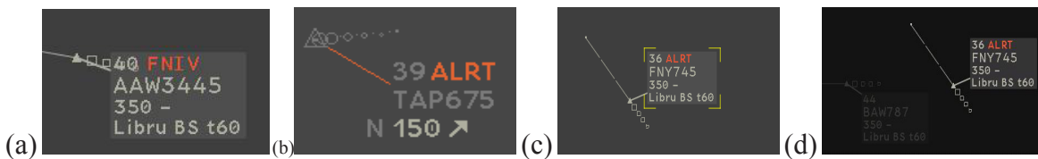
Figure 31 : notifications: (a) Color (b) ColorBlink (c) BoxAnimation (d) ShadowMask
