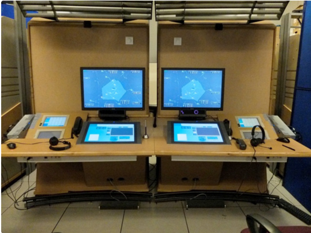
Figure 43 : position de travail Droid équipée d'oculomètres Tobii
