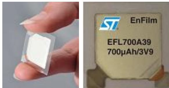
Figure I.6 : Microbatterie HiCap EnFilm (LiCoO 2 /LiPON/Li) de la société STMicroelectronics en partenariat avec la société Front Edge Technology
