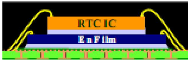
Figure I.7 : Illustration d'une approche « System in Package » couplant une microbatterie et un composant RTC
