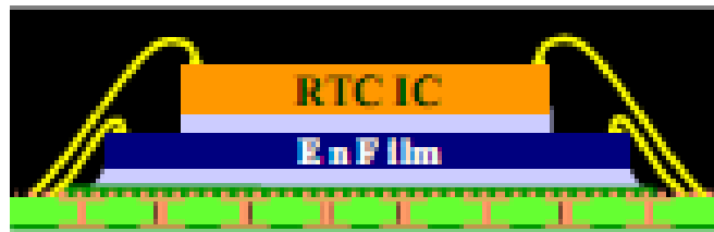
Figure I.7 : Illustration d'une approche « System in Package » couplant une microbatterie et un composant RTC
