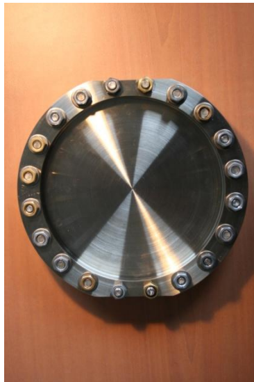
Figure V.5 : Enceinte inox pour le traitement thermique et profil de température obtenu
