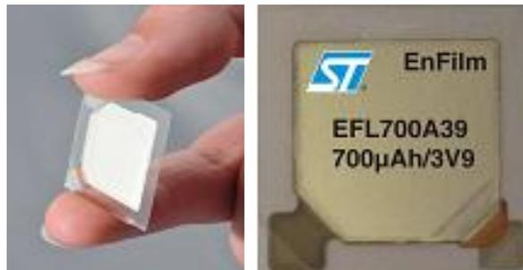
Figure I.6 : Microbatterie HiCap EnFilm (LiCoO<sub>2</sub>/LiPON/Li) de la société STMicroelectronics en partenariat avec la société Front Edge Technology
