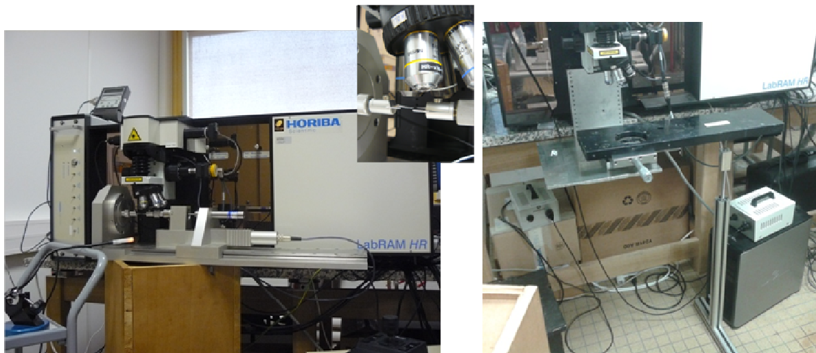
Figure E.6.1 : Photographies du montage spectroscopie Raman couplé à la traction uni-axiale avant et après 2012.
