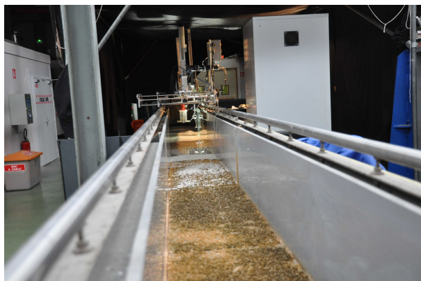
FIGURE 3.1 – Photographie du canal à surface libre.
