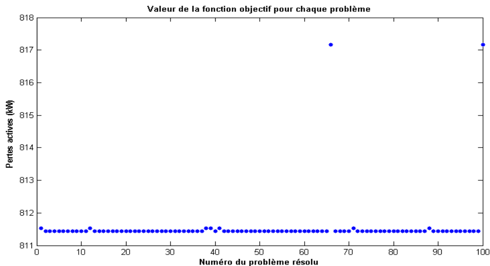
Fig 10 : Fonction objectif de 100 résolutions aléatoires dans le cas de la reconfiguration seule
