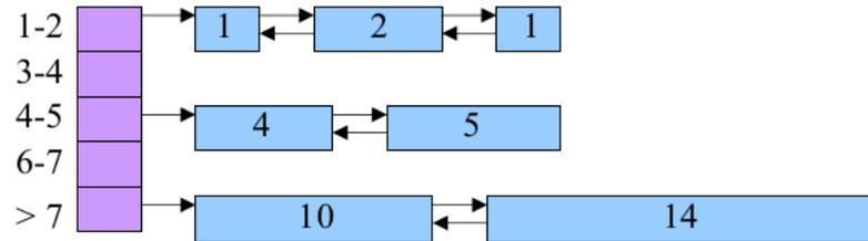
**Figure 1.7** – Stratégie d'allocation par malloc (*binning*) : par interval
