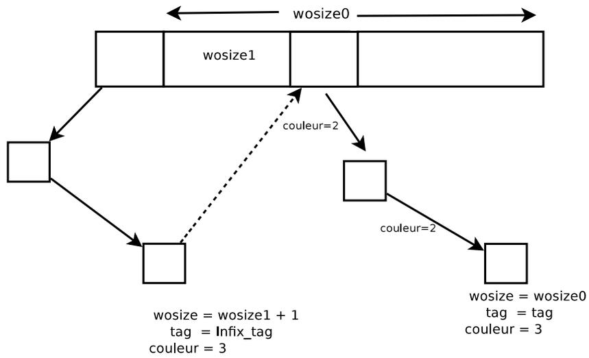
Figure 2.24 – Compaction des blocs avec un en-tête infixe.
