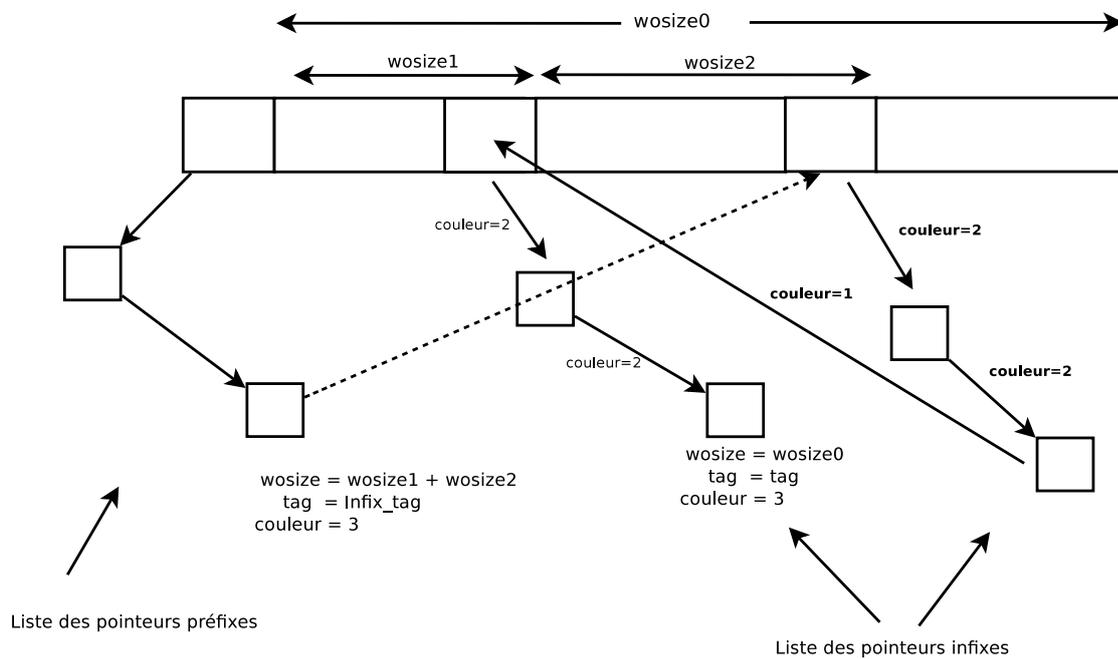
Figure 2.25 – Compaction des blocs avec plusieurs en-têtes infixes.
