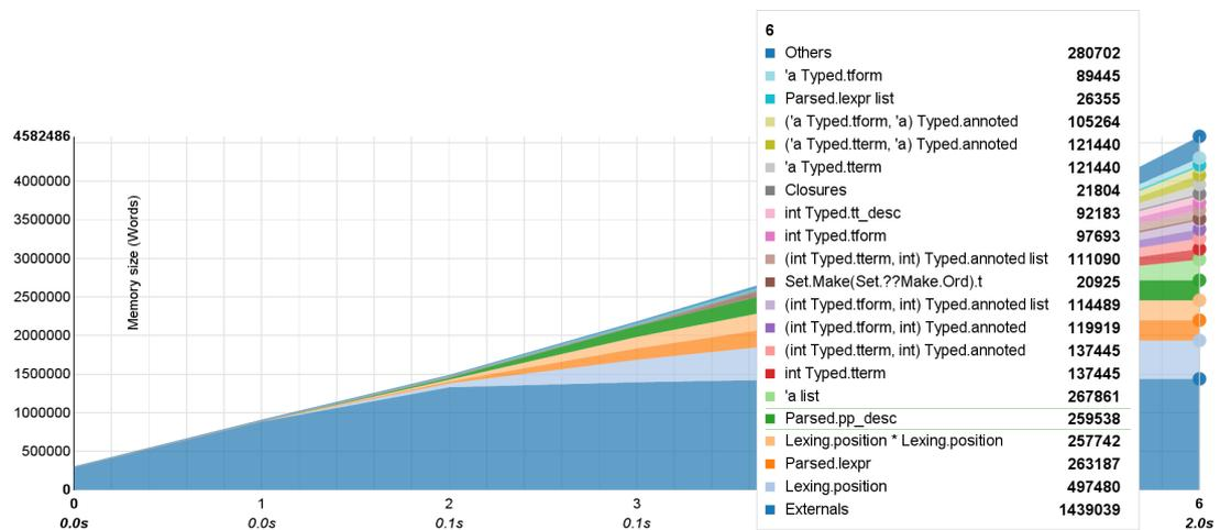
Figure 7.8 – Graphe mémoire généré à l'aide d'ocp-memprof sur une exécution d'Alt-Ergo, avec le code patché de la figure 7.7, sans la reconstruction de types.
