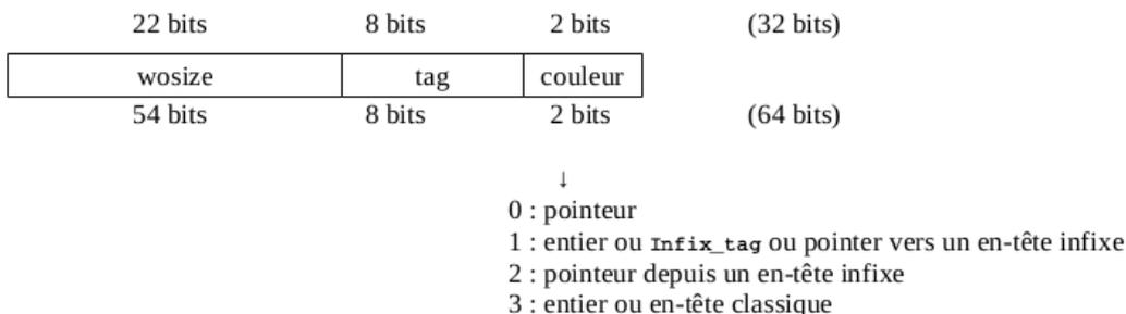
Figure 2.21 – Format des en-têtes pendant la compaction.
