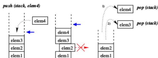
Figure 2.1 – Schéma décrivant le fonctionnement d'une pile.
