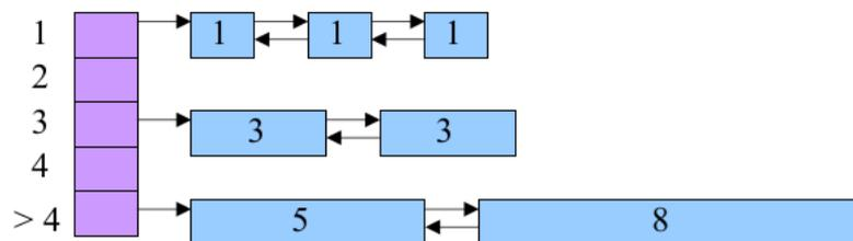
**Figure 1.6** – Stratégie d'allocation par malloc (*binning*) : exact-fit
