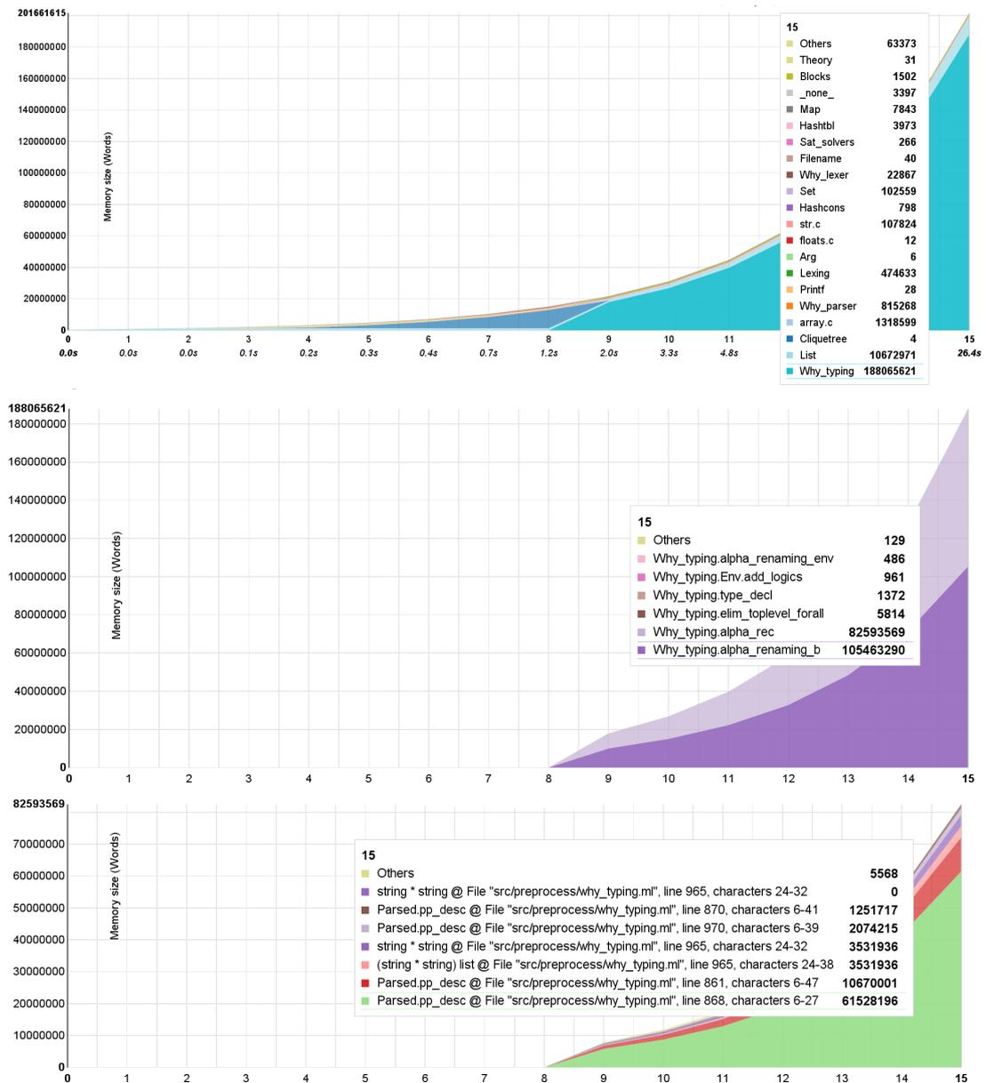
**Figure 7.5** – Graphes mémoires générés à l'aide d'ocp-memprof sur une exécution d'Alt-Ergo. Le premier graphe est le graphe global trié par modules, le second est obtenu en cliquant sur la courbe `Why_typing` et le troisième est obtenu en cliquant sur `Why_typing.alpha_renaming_b`.
