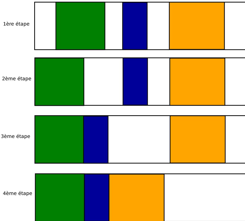
**Figure 1.4** – Algorithme de compaction classique. On déplace d’abord le bloc en vert vers le début du segment mémoire. Puis on continue avec le bloc en bleu et enfin avec le bloc en orange. Les nouvelles adresses sont stockées dans une table à part qui permet de mettre à jour les adresses à la fin de la compaction.
