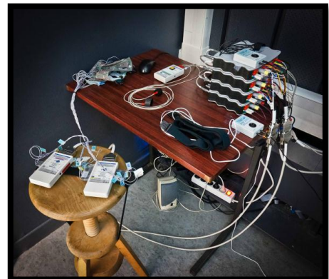
FIGURE 6.1 Photographies de la salle Persee où se déroule l'expérience (2/2) (Gauche) sujets pilotes en place pour l'expérience. (Droite) (pré-)amplificateurs, casque EEG et capteurs physiologiques.
