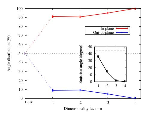
Figure 7: Proportion de phonons émis ayant une composante dans le plan (rouge) et perpendiculaire au plan (bleu), en fonction du facteur de dimensionnalité n. La ligne en pointillé noire représente le comportement bulk. La variation du cône d'émission en fonction de n est tracé sur la figure en insertion.
