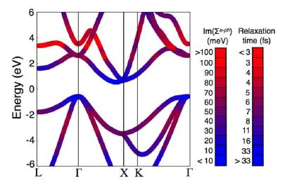
Figure 8: Structure de bande de Si. La couleur représente la partie imaginaire de la self énergie de l'élément de matrice électron-phonon. Reproduit depuis [173].
