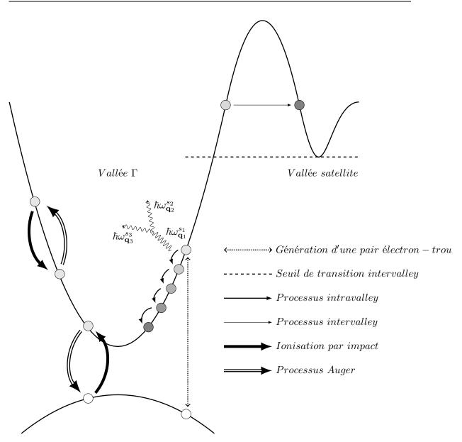
Figure 3: Processus de refroidissement des porteurs chauds.
